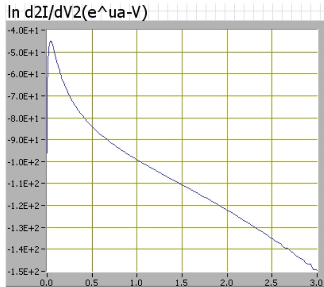
Figura 4.25: \ln(d^2I/dV^2) para un plasma de Argón. P = 4 Pa e I_d = 3 mA.
