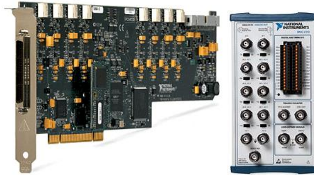
Figura 3.26: Tarjeta modelo PCI 6123 (izquierda); accesorio de conexiones BNC 2110 (derecha) de National Instruments ® .
