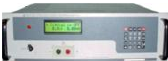
Figura 3.11: Fuente de alimentación de alta tensión modelo KEPCO BHK 2000-0.1MG.
