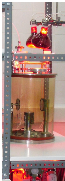
Figura 3.9: Sistema de calentamiento, del PSM y la cámara de descarga, en funcionamiento.
