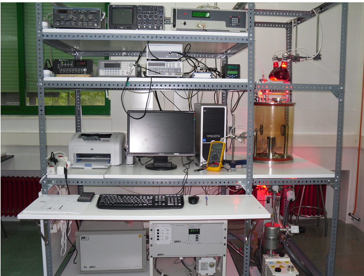
Figura 3.1: Fotografía del dispositivo experimental para la medida de curvas características I - V de una sonda electrostática de geometría cilíndrica y curvas características Ii - V de una sonda plana por especies iónicas.
