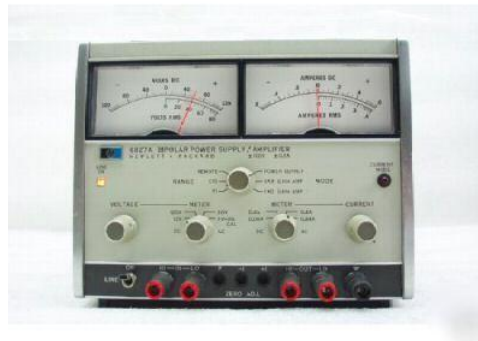
Figura 3.21: Fuente de polarización del DEPA modelo HP 6827A.
