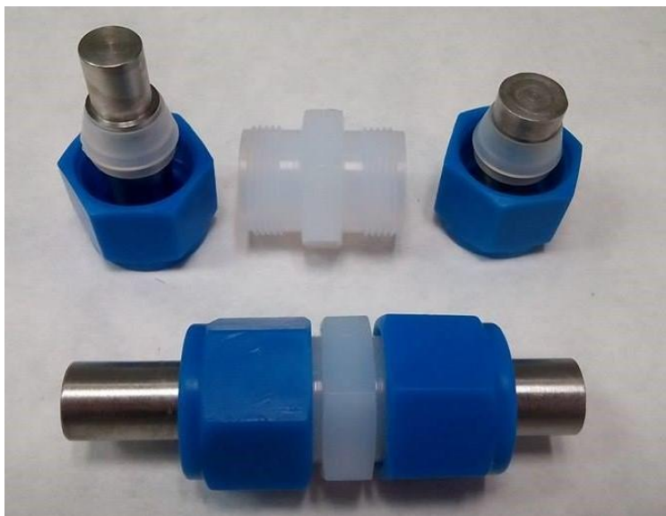
Figura 3: Celda del tipo Swagelok ® de dos electrodos utilizada para experimentos de ciclado galvanostático.
