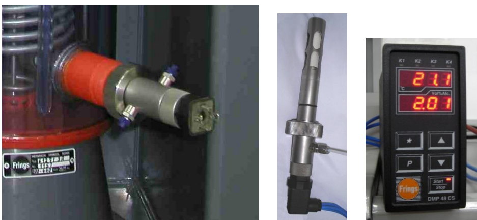
Figura A1.4.6. Sensor y transductor de la señal de la concentración de alcohol.
