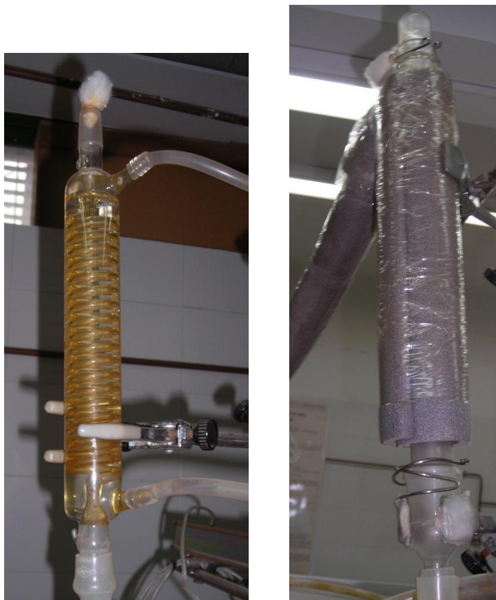
Figura A1.4.3. Fotografía del sistema de condensación empleado en la salida de gases del fermentador, sin y con recubrimiento aislante para el mejor funcionamiento.
