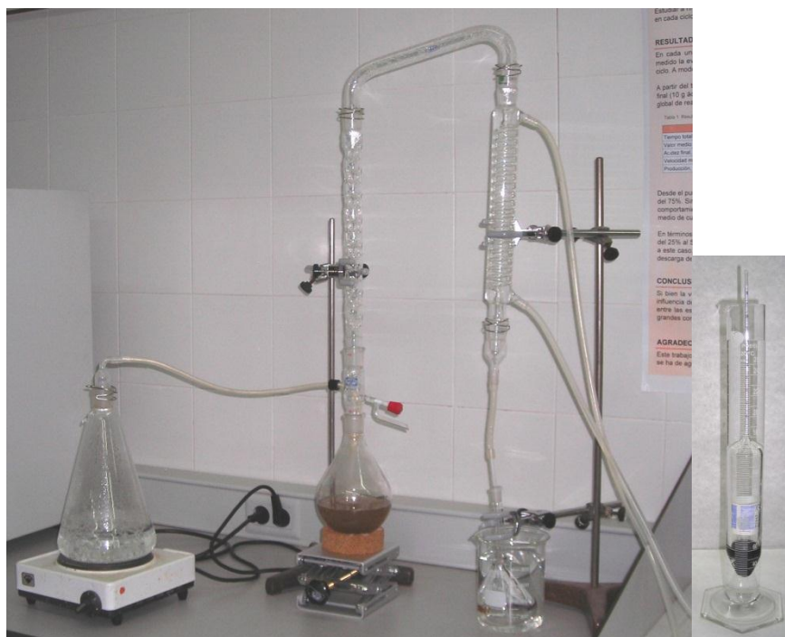
Figura A1.3.3. Fotografía del aparato de destilación y uno de los aerómetros empleados para la medida del grado alcohólico volumétrico.
