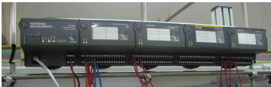
Figura A1.4.7. Módulos de adquisición y tratamiento de las señales e interfaz de red.
