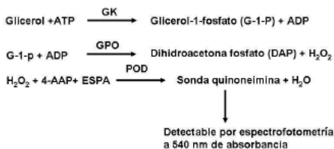
Figura 12. Reacciones que se llevan a cabo durante la cuantificación de glicerol libre en el medio.
