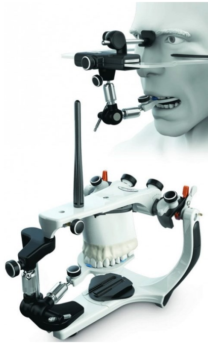
Figura 67. Conjunto de arco facial y articulador dental Arquímedes Pro donde se observa la transferencia del modelo dental (Inrodent 2017).
