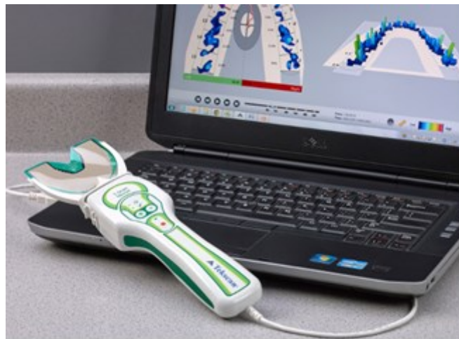
Figura 105. Sistema T-Scan para el mapeo de presión en la oclusión dental (Tekscan 2017).
