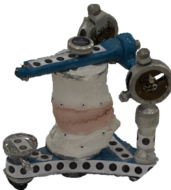
Figura 145. Modelo de malla del articulador dental Dentatus ARL escaneado junto a los modelos dentales de escayola.
