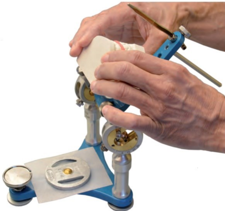
Figura 123. Montaje modelo inferior. Comprobación de altura para el montaje del modelo inferior con puntero incisal estabilizado a "0" más la suma del grosor de la cera a nivel del espacio situado entre segundo premolar y molar de los dos lados, que al ser retirada la cera se queda el puntero en el "0" real del montaje (Dentatus 2017).
