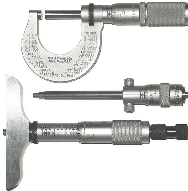
Figura 30. Instrumentos de medida: abajo se observa el medidor de profundidad y arriba se encuentra el calibrador de Palmer o micrómetro (Splarka 2005).
