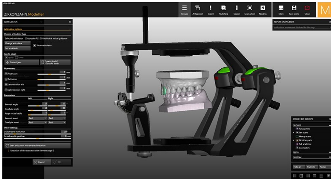
Figura 90. Módulo de articulador virtual del software CAD/CAM de Zirkonzahn (Zirkonzahn 2017).
