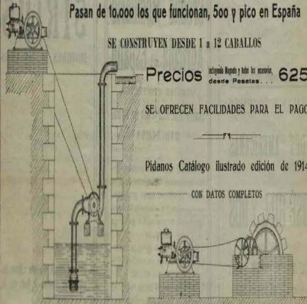
Instalación de Bomba Centrífuga
