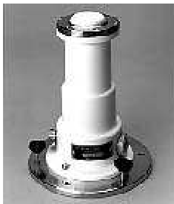
Figura 3.7.: Sensor Eppley TUVR para radiación ultravioleta
