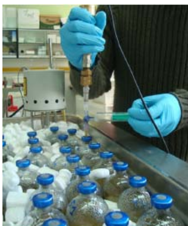
Figura 3.1. Medida de la presión y del volumen de gas de fermentación en los frascos Wheaton.
