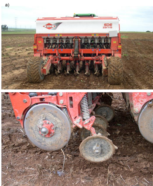
Figura 4.3 Sembradora de siembra directa de monograno realizando una siembra de trigo sobre cañotes de girasol. a) Perspectiva trasera de la sembradora con los discos y b) detalle del dispositivo de aplicación de fertilizante líquido (Palma del Condado, Huelva; enero 2014)
