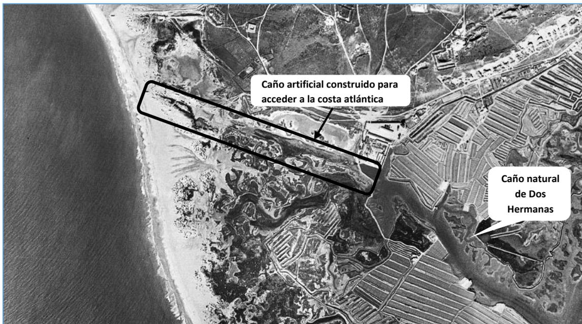
Figura 32. Detalle de ortofoto de la Junta de Andalucía en la que se aprecia claramente como en 1956 existían todavía restos del canal construido en 1810 desde el caño de Dos Hermanas hasta el océano Atlántico. Sistema de Información Geográfica Junta de Andalucía
