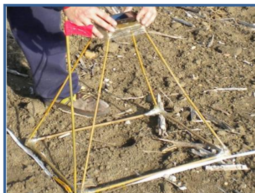
Soporte fabricado para tomar las fotografías del suelo usadas para la estimación visual del contenido de biochar.
