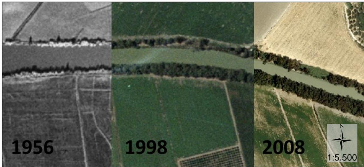
Figura 35. Avance la vegetación versus pérdida de sección disponible para la descarga de caudales.
