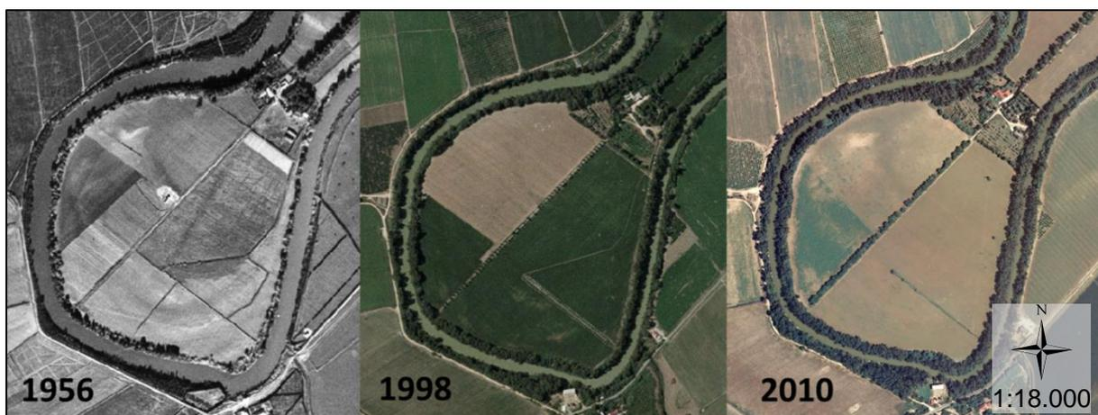
Figura 36. Avance la vegetación versus pérdida de sección disponible para la descarga de caudales.
