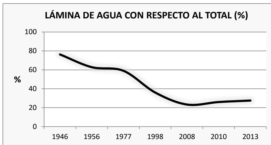
Figura 37. Relación ancho lámina de agua con anchura total del río.
