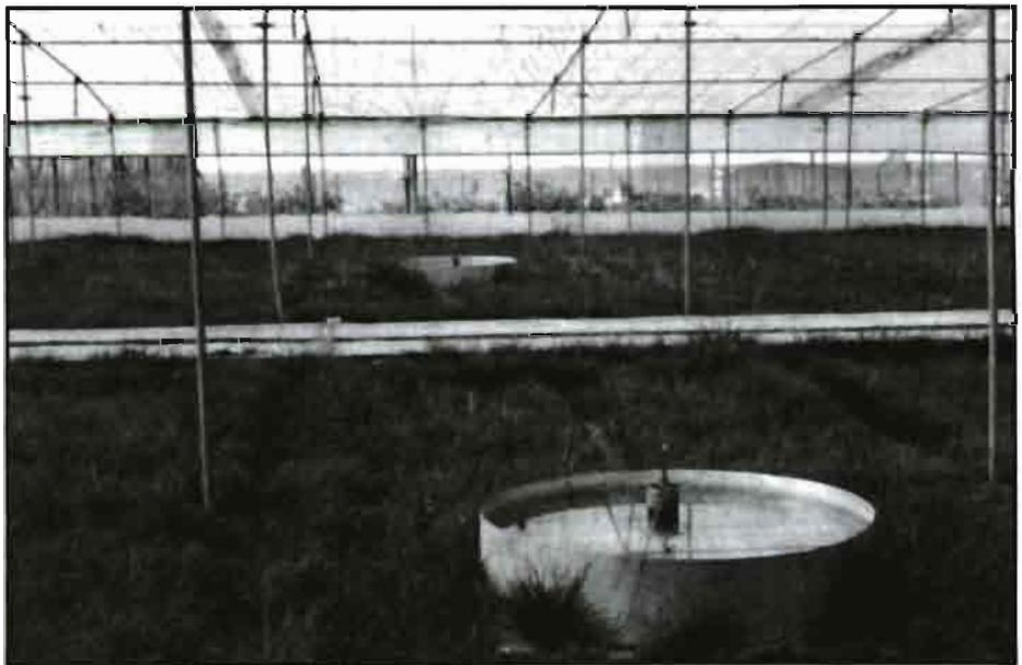
*Evaporímetro de cubeta o tanque evaporimétrico clase A, situado dentro de invernadero. El conocimiento del espesor de la lámina de agua evaporada, permite estimar las necesidades de riego*
