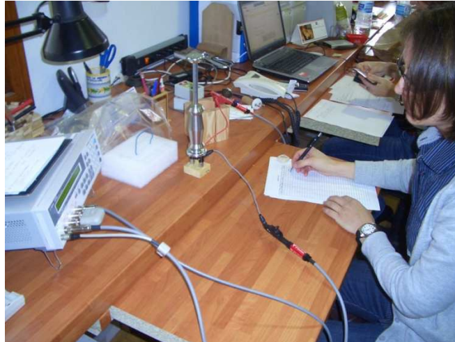
Figura 12. Equipos de medida de la resistencia eléctrica.
