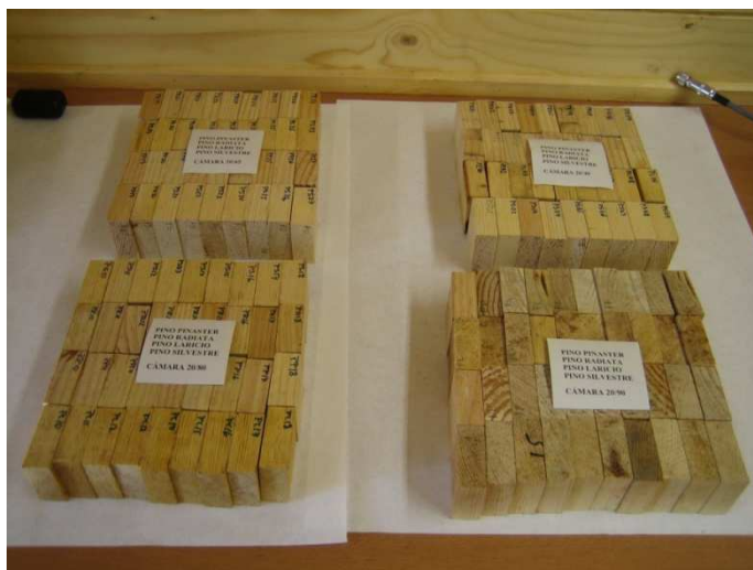
Figura 11. Probetas de ensayo utilizadas en el estudio ( P. pinaster , P. radiata , P. nigra y P. sylvestris ) bajo las siguientes condiciones de temperatura y HR: arriba-izquierda 20/65; arriba-derecha 20/40; abajo-izquierda 20/80 y abajo-derecha 20/90.
