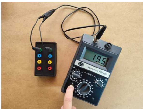
Figura 13. Detalle de la caja y cables de conexión del emulador al xilohigrómetro en verificación/calibración.
