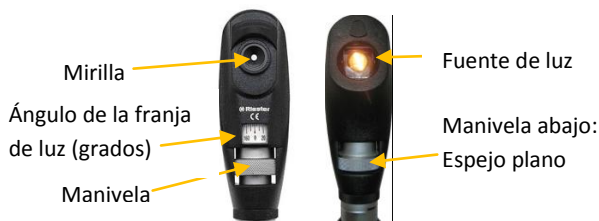
Figura 15: Cabeza del retinoscopio Ri-tinoscope.
