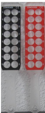
Figura 17: Barras de lentes. Convergentes (negra), divergentes (roja).
