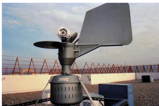
Figura 2.3. Captador instalado en la azotea de la Facultad de Ciencias de la Educación a unos 15 metros del nivel del suelo. Levantado del suelo de la azotea por una torreta metálica.
