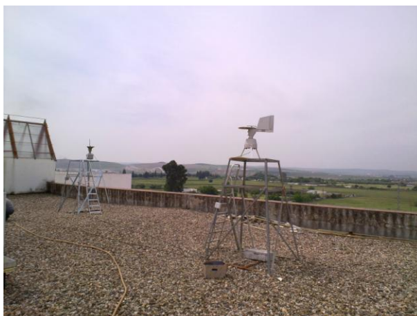
Figura 2.5. Captadores tipo Hirst instalados para el control en la zona suroeste.
