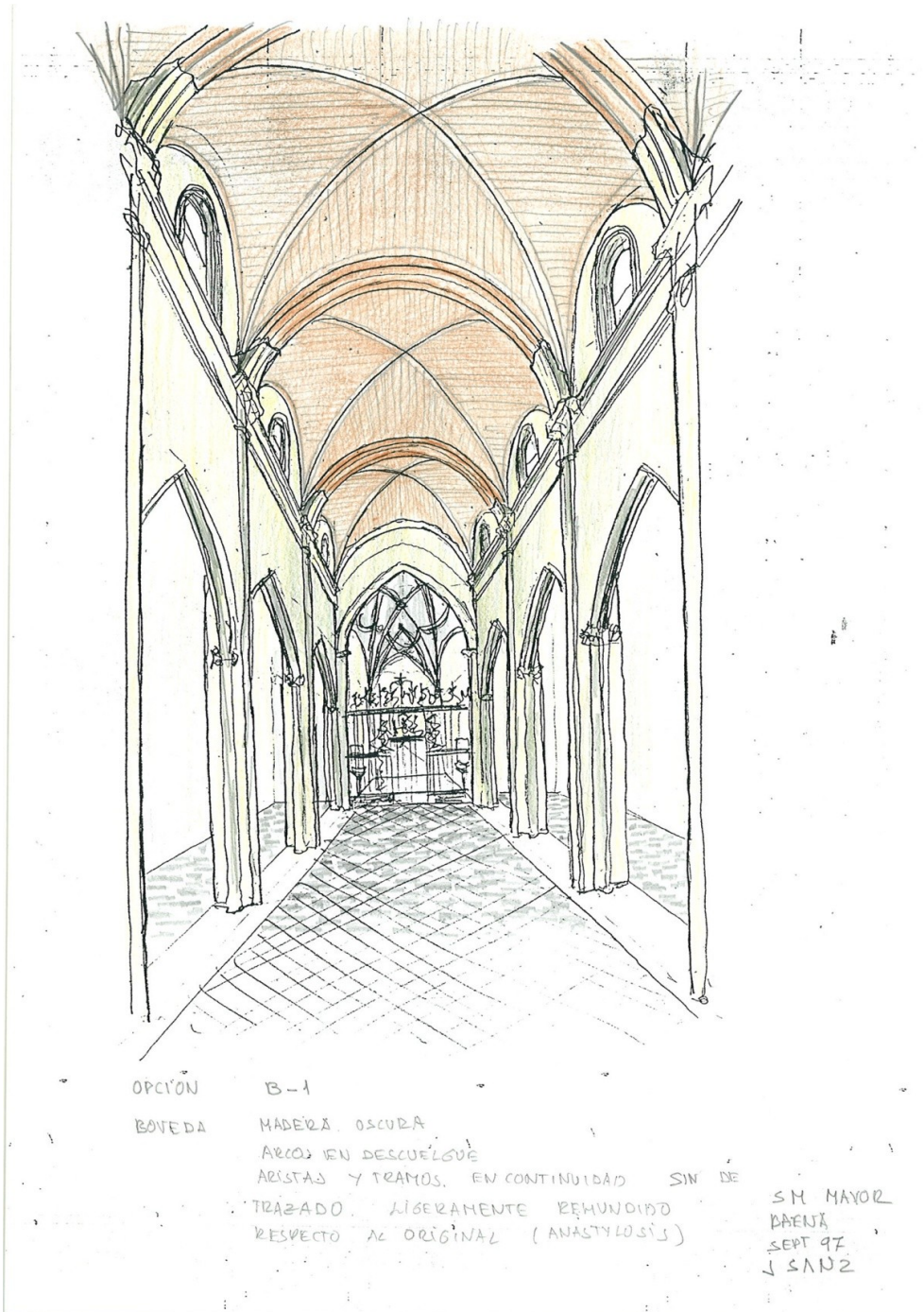
Figura 334 Croquis dibujado por el autor en la fase de proyección de la intervención en S.M.M.
