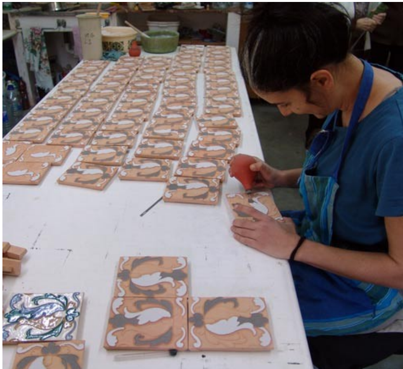
Figura 164 Prefabricación para restauración http://fernandomalo.blogia.com/upload/20120408234444-restauracion-de-la-restauracion.jpg
