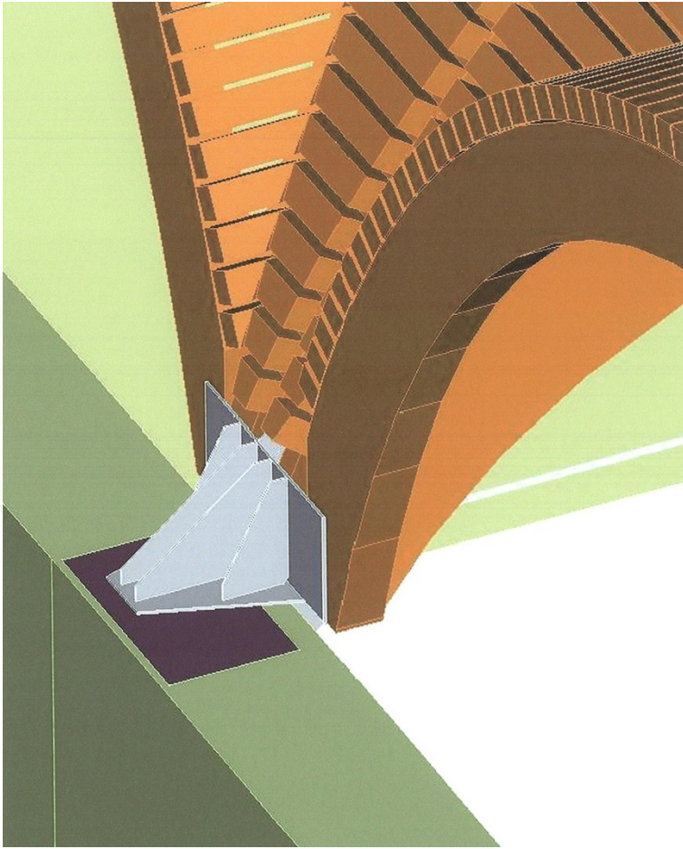
Figura 356 Infografías del estudio técnico de las bóvedas de madera laminada, en el proyecto y obra de restauración redactado por el autor. Imagen del nudo de apoyo.
