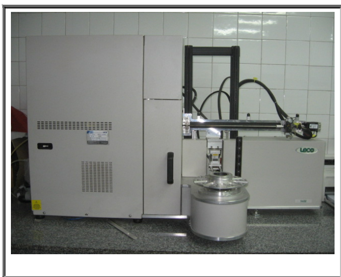
Figura 4.3.12.2.1. Equipo de análisis de azufre marca LECO modelo S632. Central Térmica de Puente Nuevo.
