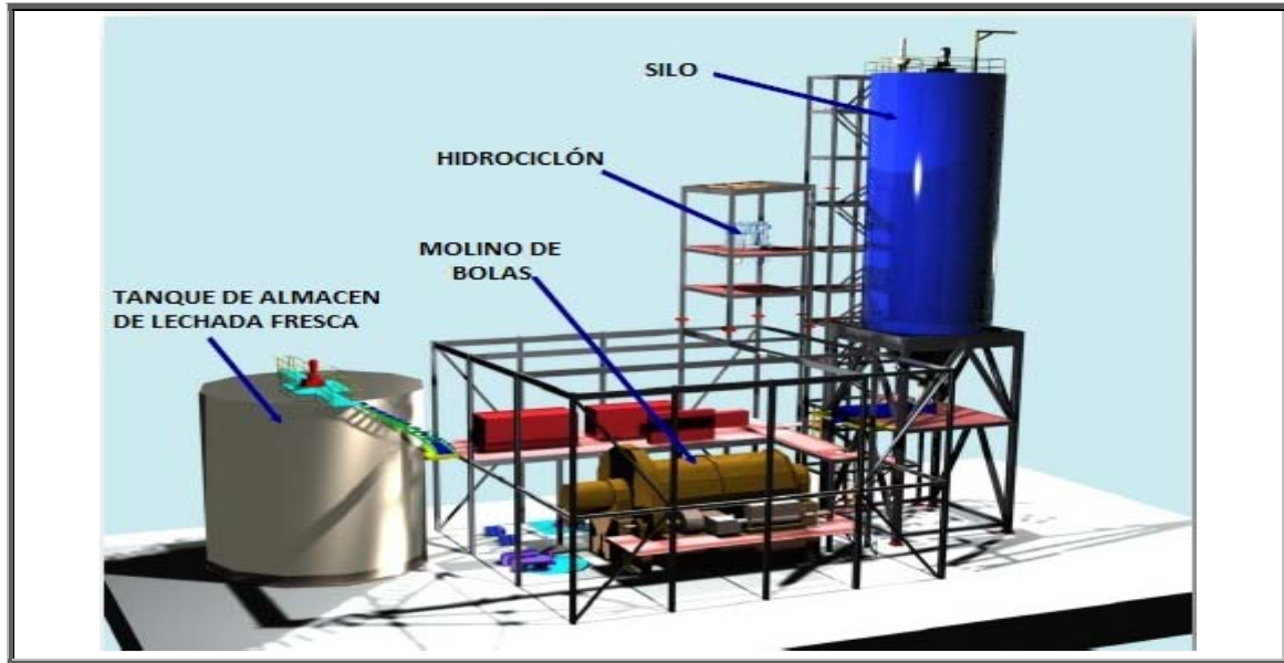
Figura 4.1.2.7.1. Vista en 3D del sistema de molienda de la Central Térmica de Puente Nuevo.
