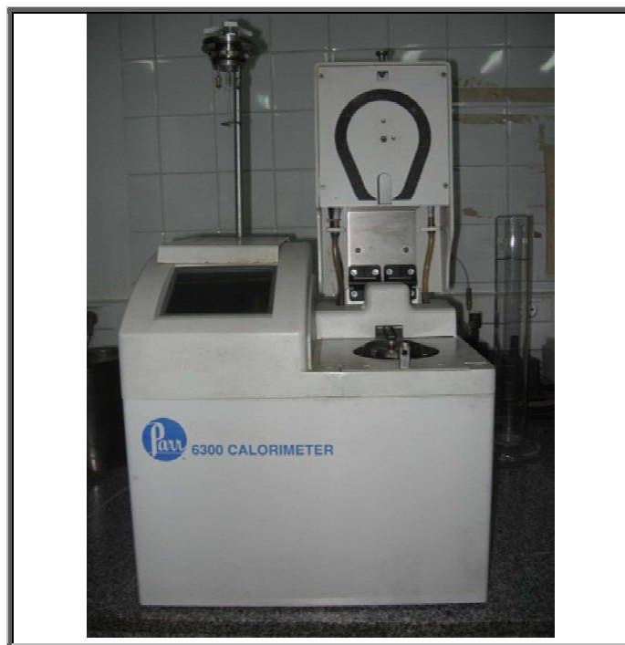
Figura 4.3.12.3.1. Bomba calorimétrica Parr 6300 Calorimeter de la Central Térmica de Puente Nuevo
