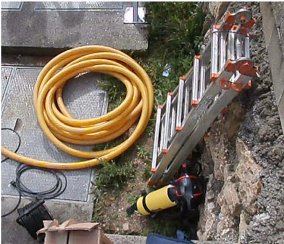
*Figura 44: Escalera portátil telescópica utilizada en acceso a algunos EECC.*
