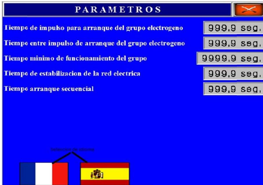
Figura 162: Pantalla de parámetros ajustables por el operario
