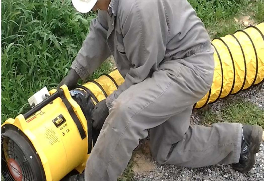
*Figura 78: Operario montando el ventilador de aire*
