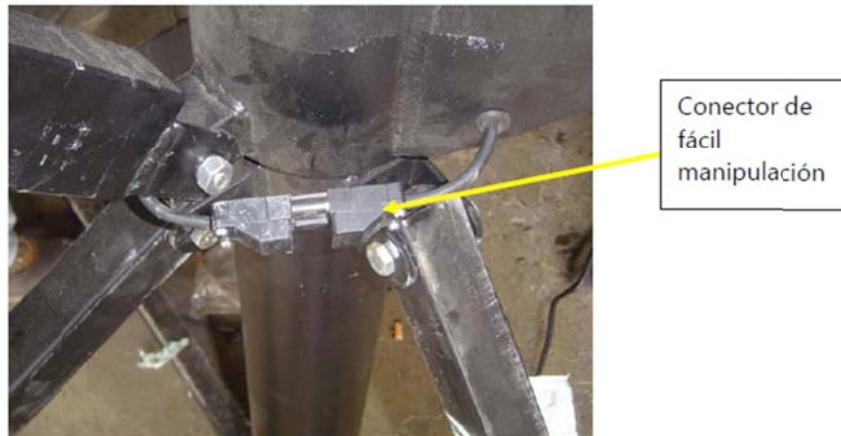
*Figura 115: Detalle ficha de conexión del polipasto elevador GM-500*
