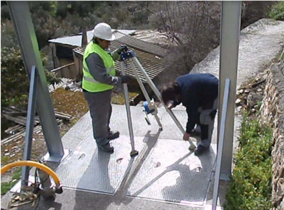
*Figura 84: Montaje del trípode*
