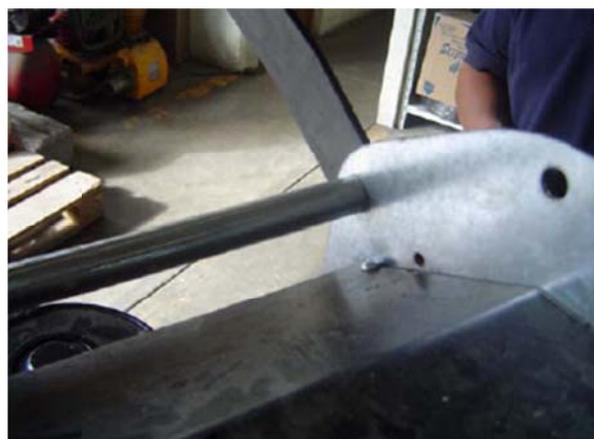
*Figura 116: Detalle estructura de los tirantes del polipasto elevador GM-500*
