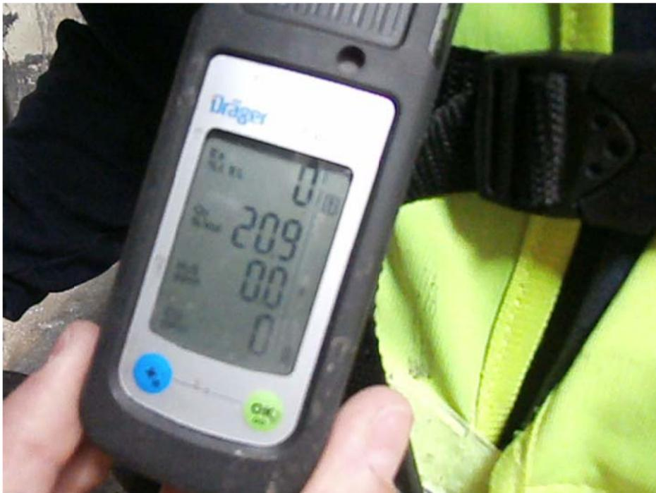
*Figura 67: Medidor de gases con cuatro sensores Dräger X-am 2000*
