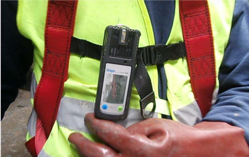
*Figura 66: Medidor personal de H<sub>2</sub>S - MINIPAC*
