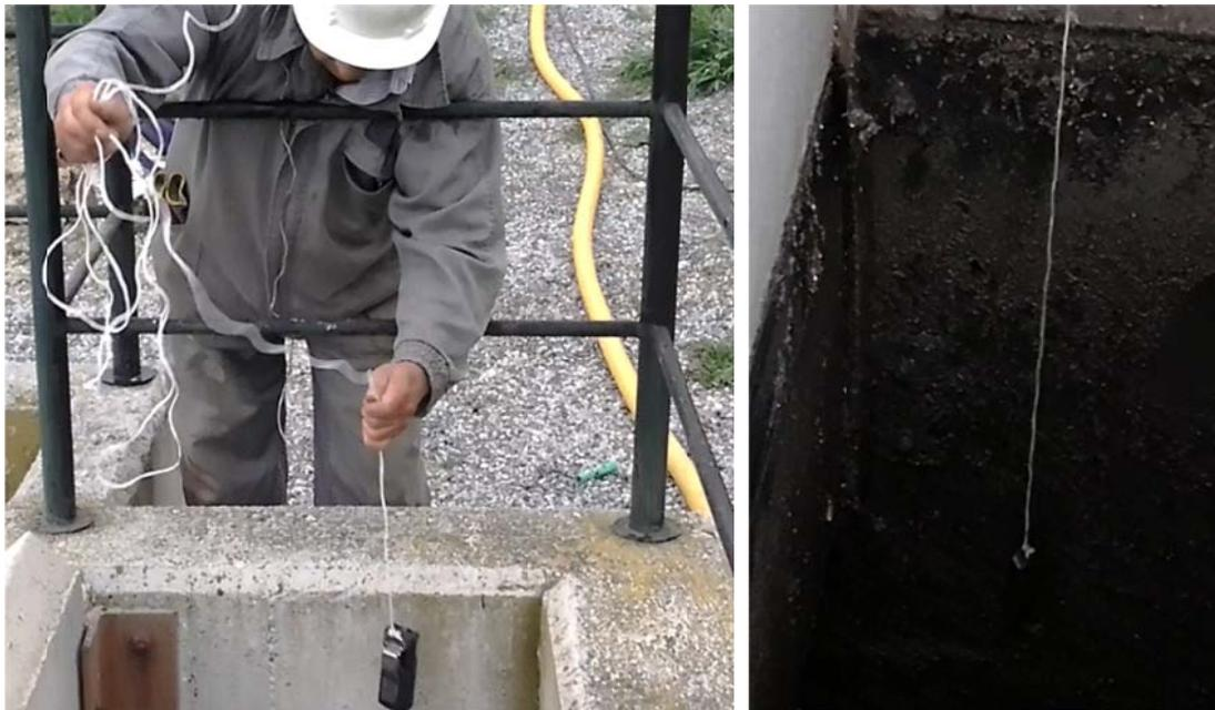
*Figura 80: Colocación del medidor de gases en el interior del tanque Imhoff*
