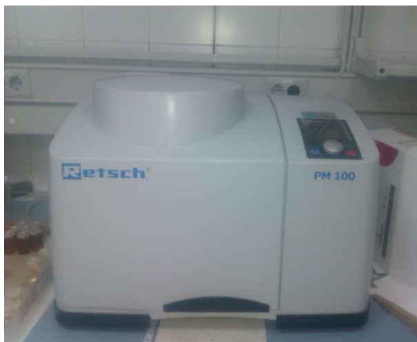
Figura 2.14. Molino de bolas Retsch PM 100.
