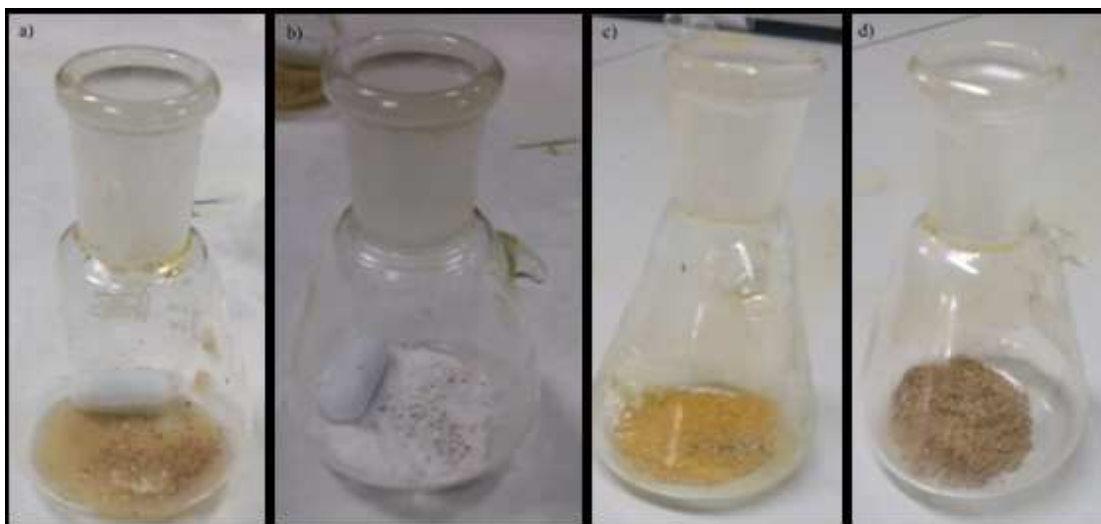
Figura 3.7. Soportes empleados para la inmovilización de la lipasa Rhizomucor miehei de Novozyme, ya fijada a un polímero (a) sepiolita desmineralizada, (b) silicagel, (c) \text{AlPO}_4 /Sepiolita activado con 4-aminobencilamina y (d) \text{AlPO}_4 /Sepiolita activado con p-hidroxibenzaldehído.
