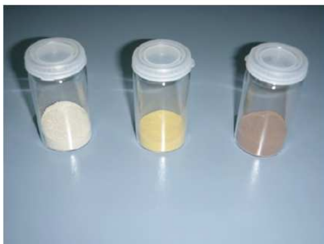
Figura 2.12. De izquierda a derecha se presentan las imágenes de (a) soporte Sepiolita/ \text{AlPO}_4 ; (b) soporte activado después del calentamiento por microondas con 4-aminobenzilamina, (c) soporte funcionalizado con el tereftaldialdehído.
