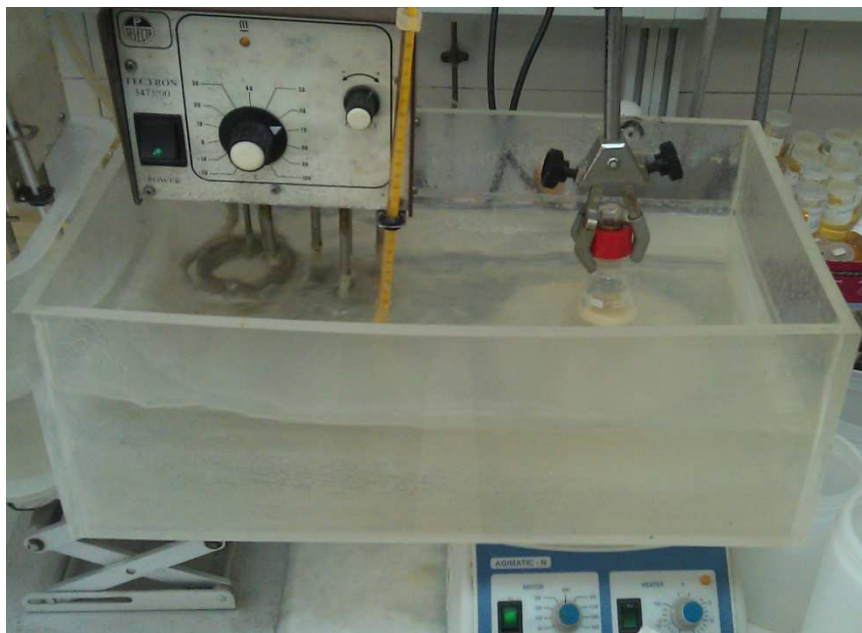
Figura 2.16. Dispositivo experimental utilizado para efectuar la reacción de transesterificación de aceite de girasol para la obtención de Biocombustible.
