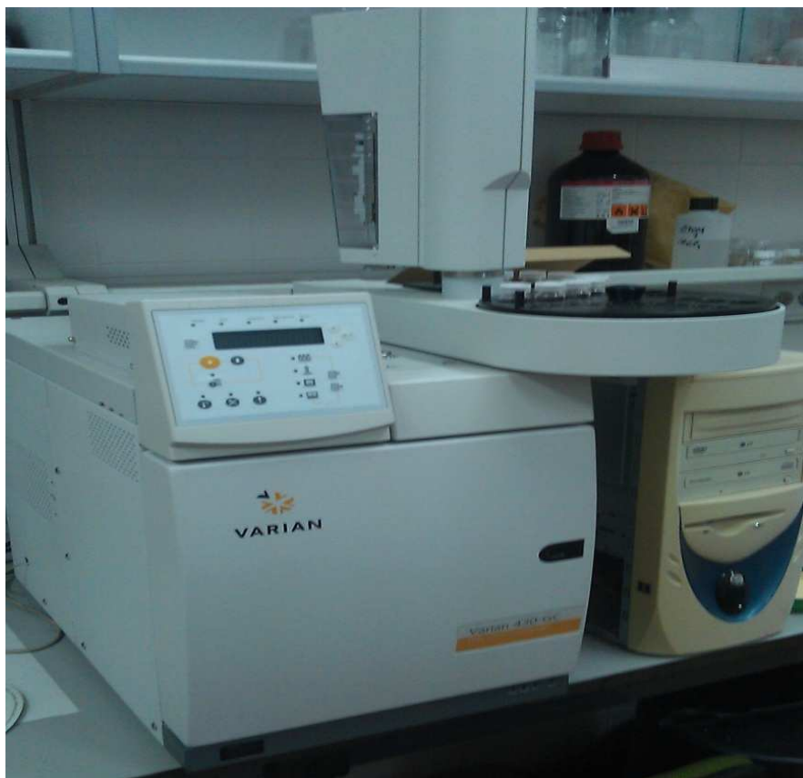
Figura 2.1. Cromatógrafo Varian 430 GC Gas Chromatograph, utilizado para el análisis de la composición del biocombustible.
