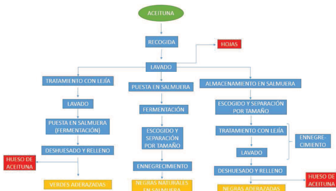
Figura 19. Esquema del proceso de obtención de las aceitunas de mesa y subproductos generados (Fuente: Elaboración propia).
