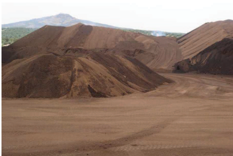
Fotografía 18. Parque de almacenamiento de orujillo en planta de generación de energía eléctrica con biomasa (La Cal, 2013).
