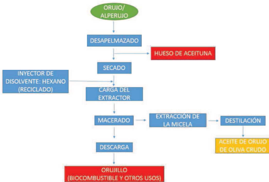
Figura 18. Esquema del proceso de extracción del aceite de orujo del alperujo u orujo y subproductos generados (Fuente: Elaboración propia).
