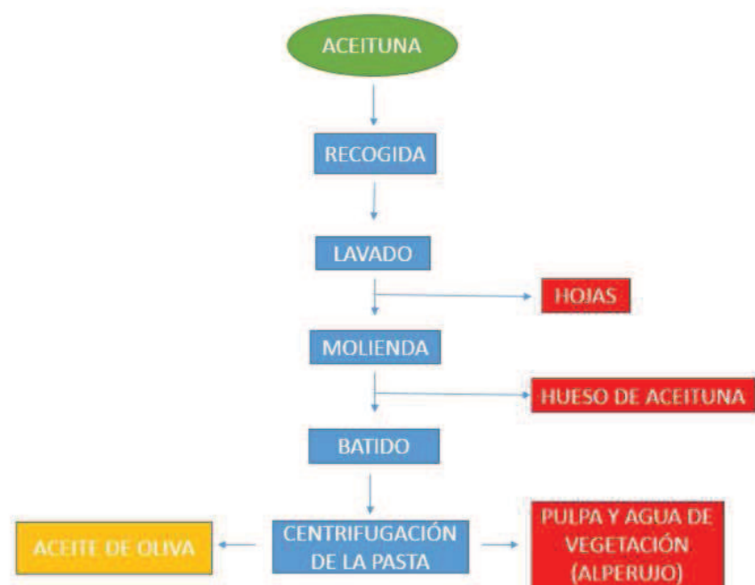
Figura 17. Proceso de elaboración del aceite de oliva y generación de subproductos en un sistema de dos fases (Fuente: Elaboración propia).
