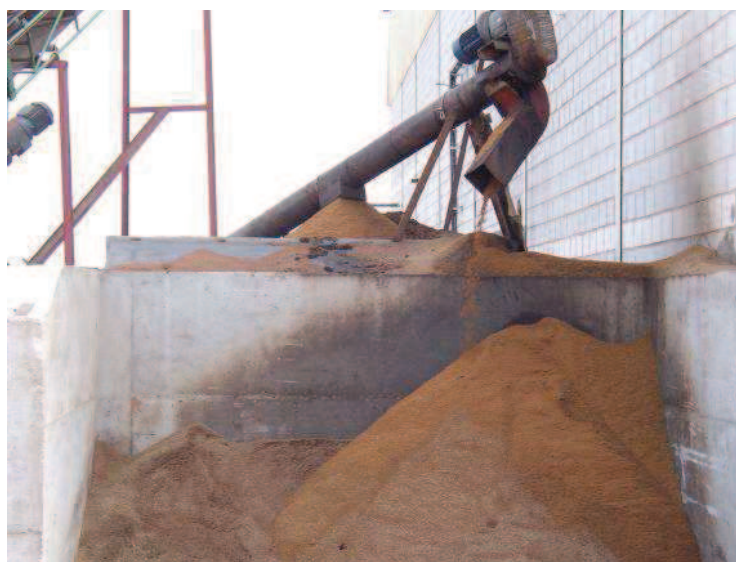
Fotografía 15. Separación de hueso de aceituna en almazara (Agencia Andaluza de la Energía (AAE), 2013).
