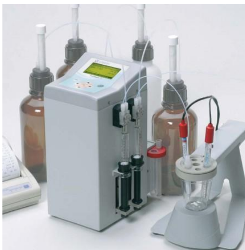
Figura 2.1. Valorador automático TitroMatic 2S 2B ("Karl-Fischer") empleado para determinar el contenido en agua del aceite vegetal usado como materia prima.
