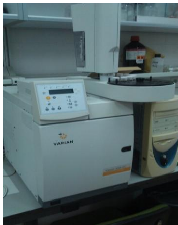
Figura 2.4. Cromatógrafo Varian 430 GC Gas Chromatograph, utilizado para el análisis de la composición del biocombustible.
