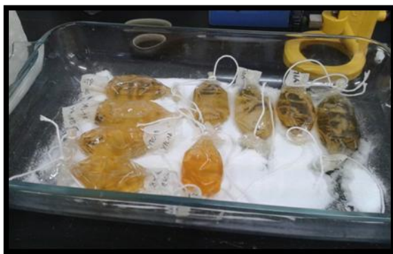
Figura 2.14. Proceso de diálisis previa a la liofilización para la obtención de los extractos enzimáticos. (a) Preparación de las muestras para dializar, con las membranas en forma cilíndrica característica. (b) Lavado con tampón fosfato de las muestras para diálisis.
