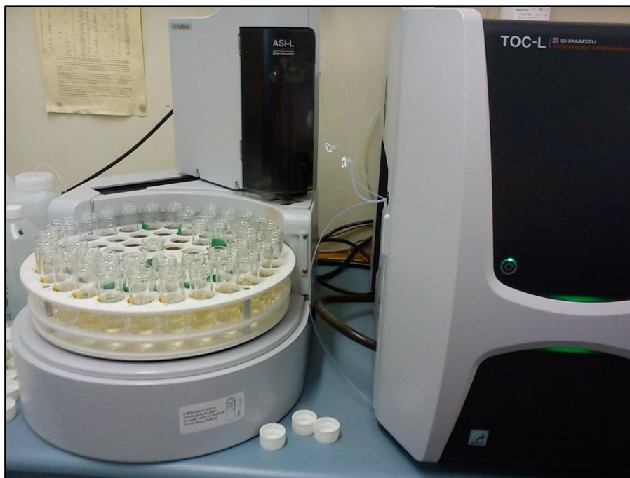
Figura 21. Equipo para medir el DOC (del C extraído). Elaboración propia.
