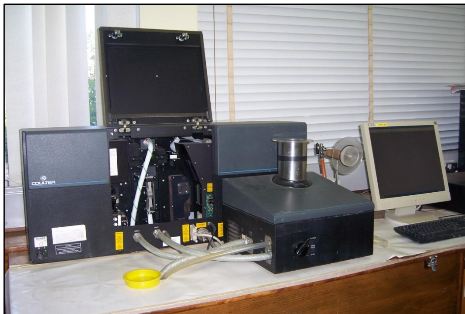
Figura 19. Equipo para medir la textura mediante granulometría láser. Elaboración propia.
