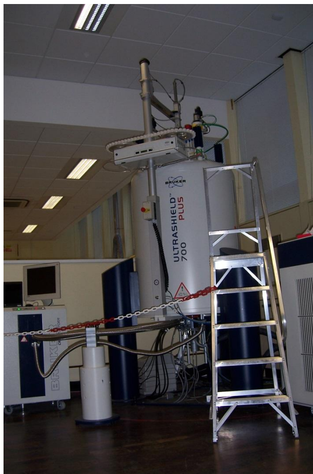
Figura 22. Equipo para medir la ^1\text{H-NMR} . Elaboración propia.
