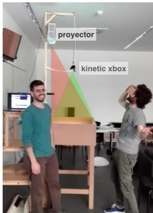
Figura 3: Diagrama del arenero educativo. La mesa contiene el arenero y encima la cámara infrarroja (kinetic xbox), arriba el proyector que produce la imagen sobre la arena.
