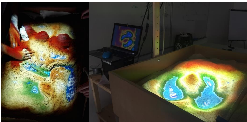
Figura 1. El arenero educativo en funcionamiento. En las imágenes se puede ver la proyección de la capa digital sobre el arenero y como cambia cuando se modifica la superficie. Fuente: Elaboración propia
