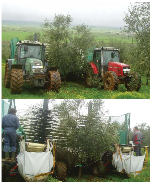
Fig. 10. Cosechadora side by side arrastrada y basada en la sacudida de copa desarrollada por la Universidad de Évora y la empresa Vicort (Peça, Pinheiro, Dias, Cardoso 2013).
