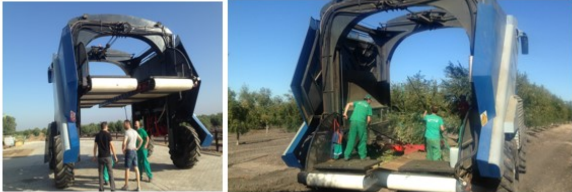
Fig. 8. Cosechadora cabalgante basada en la vibración de tronco para olivar intensivo.
