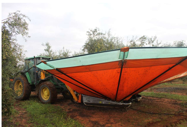
Fig. 11. Paraguas invertido con vibrador de troncos recogiendo en una finca de olivar intensivo.
