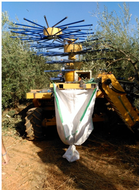
Fig. 9. Sacudidor de copa lateral en olivar intensivo. Este sistema debe realizar dos pasadas por línea de árboles.
