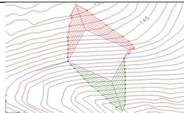
**60. Si la línea roja determina los límites de una futura vía, plana, a +145,00, sabrías determinar que parte de la misma va a estar sometida a terraplén.**
