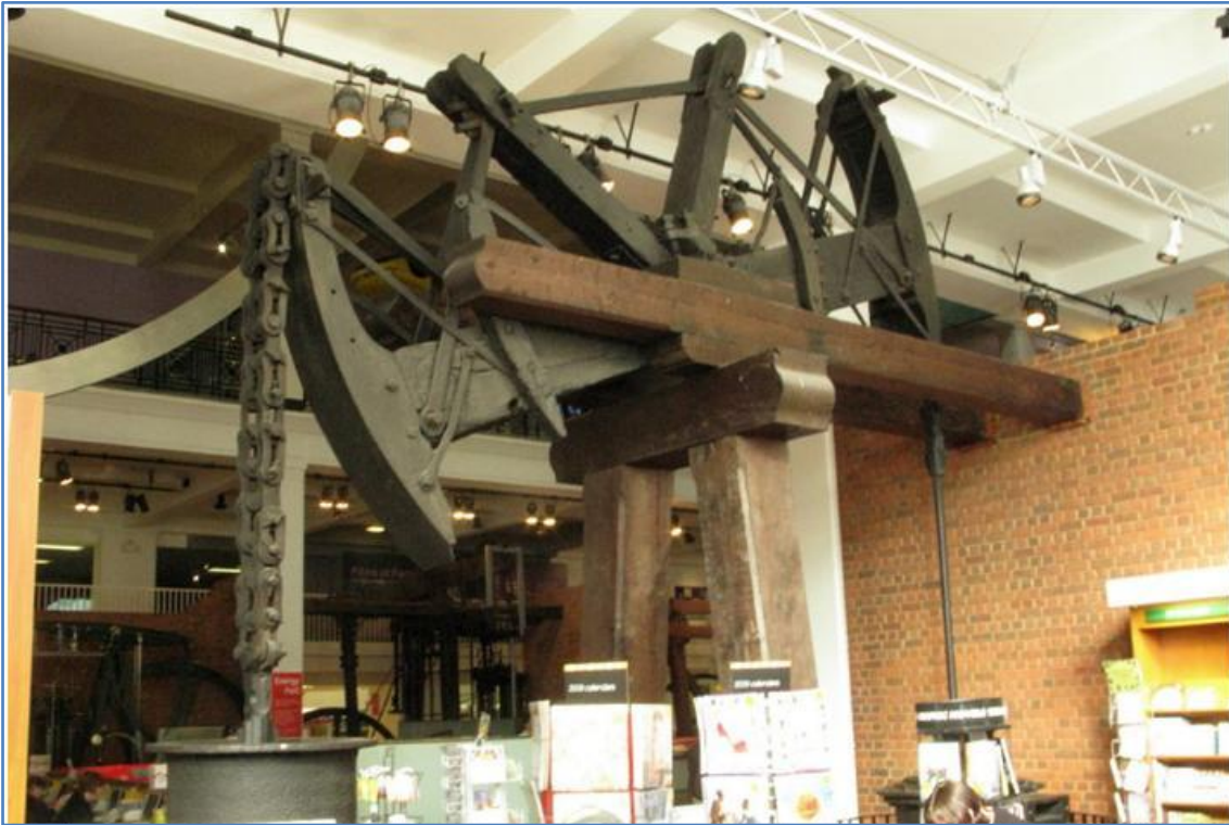
Figura 124. Balancín de madera de la máquina de vapor de Watt en el museo de Londres. Fuente: http://advrider.com 20/01/2017
