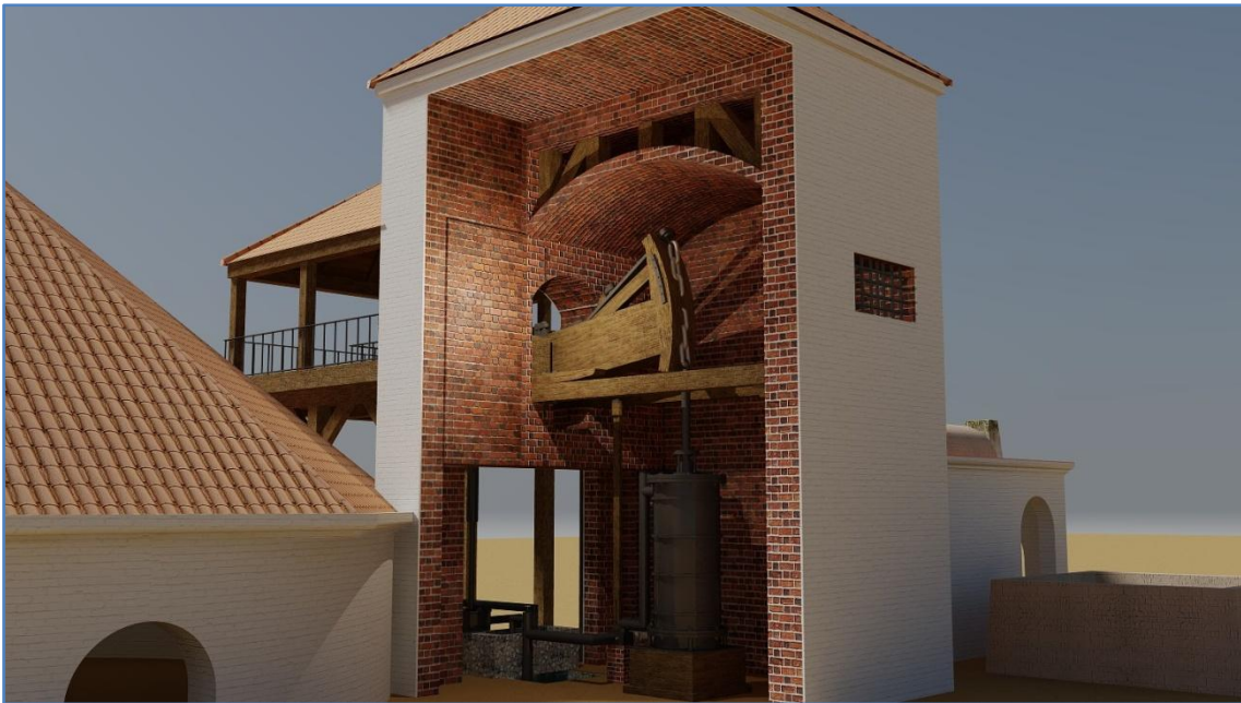
Figura 166. Sección del edificio de la 1ª máquina de vapor de minas de Almadén. Fuente: (Fernández Sánchez & Calderón Herrera, 2016)
