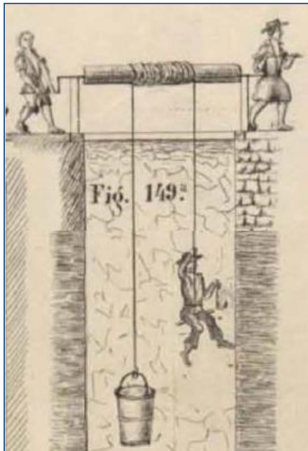
Figura 21. Bajada a la mina mediante el torno de mano. Fuente: (Ezquerria del Bayo, 1851)
