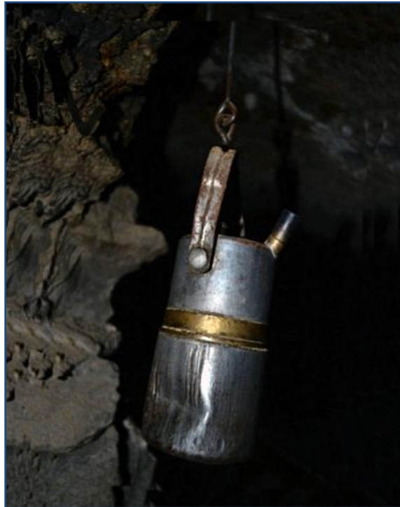
Figura 37. Lámpara de Carbuero de Minas de Almadén. Fuente: Parque Minero de Almadén.
