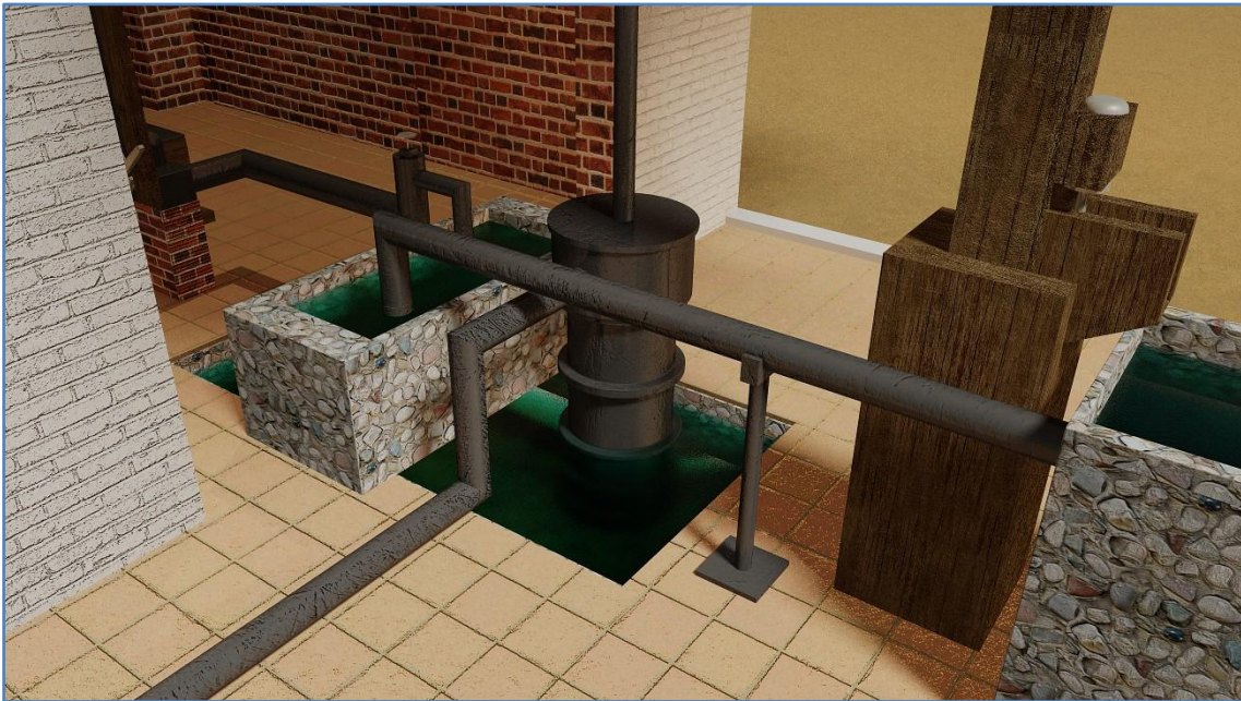
Figura 138. Condensador de la 1ª máquina de vapor de minas de Almadén. Fuente: (Fernández Sánchez & Calderón Herrera, 2016)
