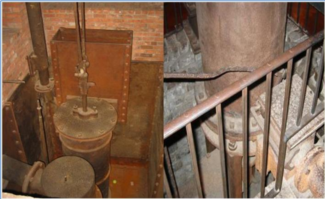
Figura 123. Cilindro máquina de vapor de James Watt. Fuente: http://technology.niagarac.on.ca 20/01/2017
