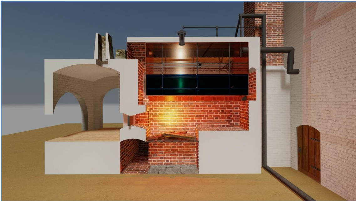
Figura 176. Render sección de la caldera de la 1ª máquina de vapor de minas de Almadén. Fuente: (Fernández Sánchez & Calderón Herrera, 2016)
