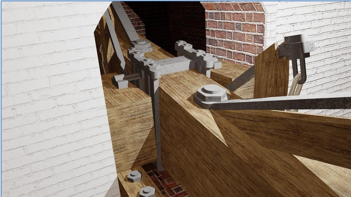
Figura 140. Detalle fijación eje balancín de la 1ª máquina de vapor de minas de Almadén. Fuente: (Fernández Sánchez & Calderón Herrera, 2016)
