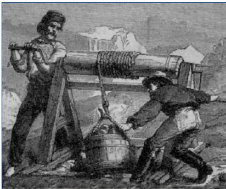
Figura 11. Extracción de mineral mediante torno de mano. Fuente: http://www.regmurcia.com Consultada 16/01/2015
