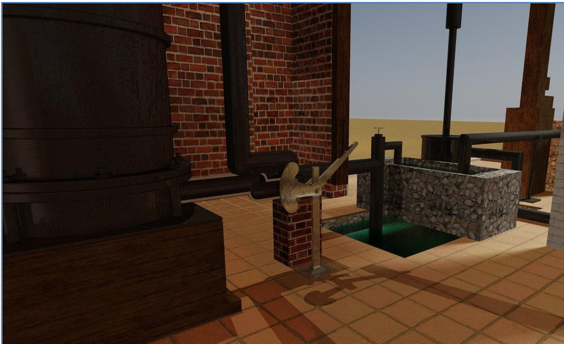
Figura 137. Detalle conexión válvula de regulación al cilindro y al condensador de la 1ª máquina de minas de Almadén. Fuente: (Fernández Sánchez & Calderón Herrera, 2016)
