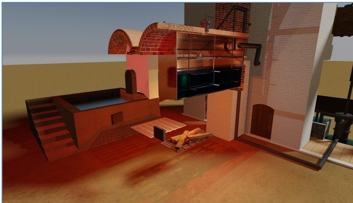
Figura 134. Ensamblaje 02 de elementos de las calderas de la 1ª máquina de vapor de minas de Almadén. Fuente: (Fernández Sánchez & Calderón Herrera, 2016)
