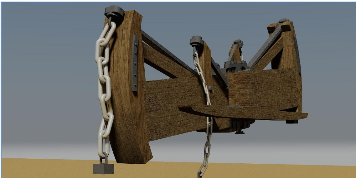
Figura 152. Balancín de la 1ª máquina de vapor de minas de Almadén. Fuente: (Fernández Sánchez & Calderón Herrera, 2016)
