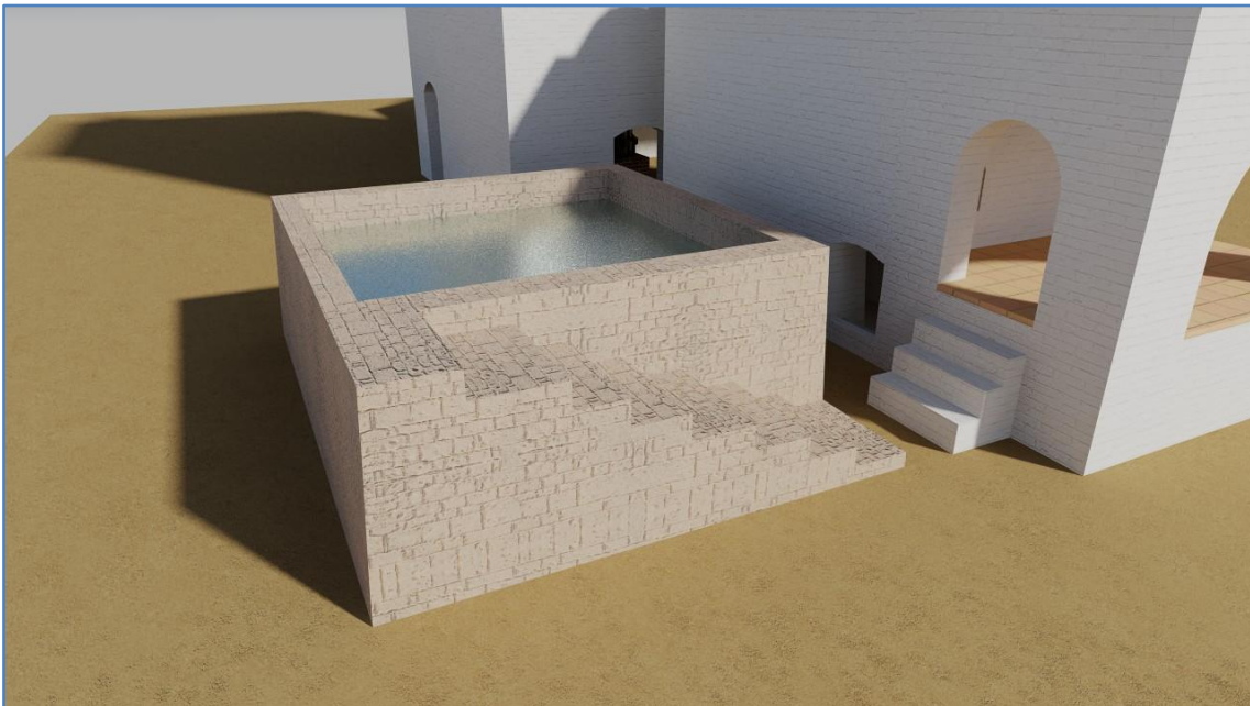
Figura 156. Depósito o balsa principal para el abastecimiento de agua de las calderas de la 1ª máquina de vapor de minas de Almadén. Fuente: (Fernández Sánchez & Calderón Herrera, 2016)
