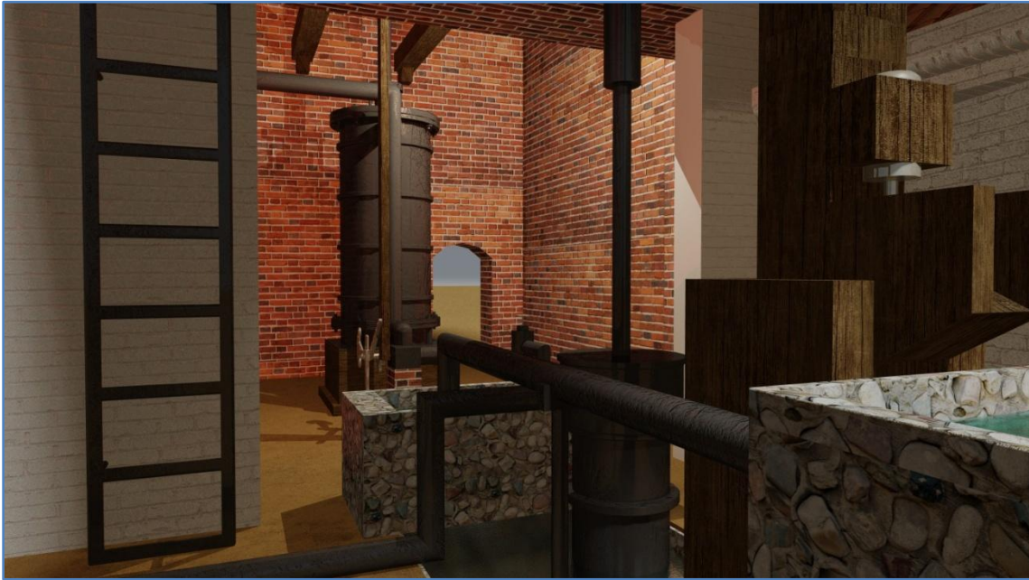
Figura 180. Render cilindro y condensador de la 1ª máquina de vapor de minas de Almadén. Fuente: (Fernández Sánchez & Calderón Herrera, 2016)
