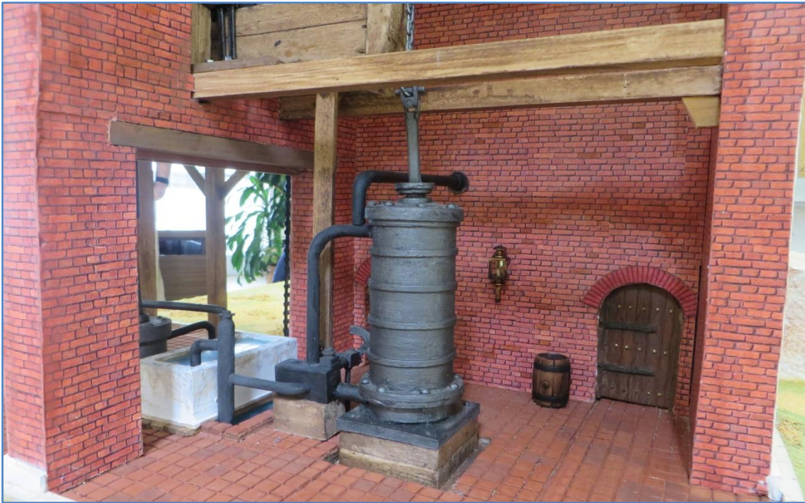
Figura 189. Interior edificio de la maqueta de la primera máquina de vapor de minas de Almadén. Fuente: (Molina de las Heras & Calderón Herrera, 2016)
