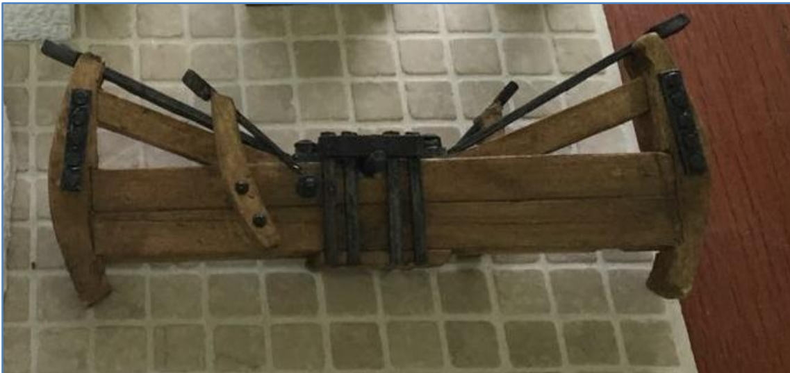
Figura 181. Balancín maqueta de la 1ª máquina de vapor de minas de Almadén. Fuente: (Molina de las Heras & Calderón Herrera, 2016)
