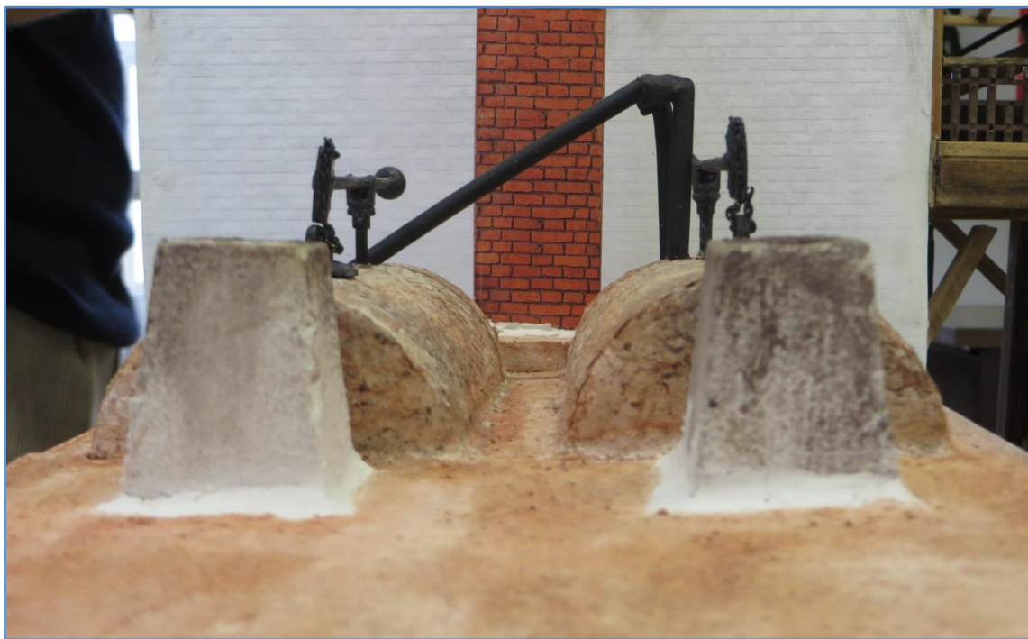
Figura 194. Cubierta de las calderas de la maqueta de la primera máquina de vapor de minas de Almadén. Fuente: (Molina de las Heras & Calderón Herrera, 2016)
