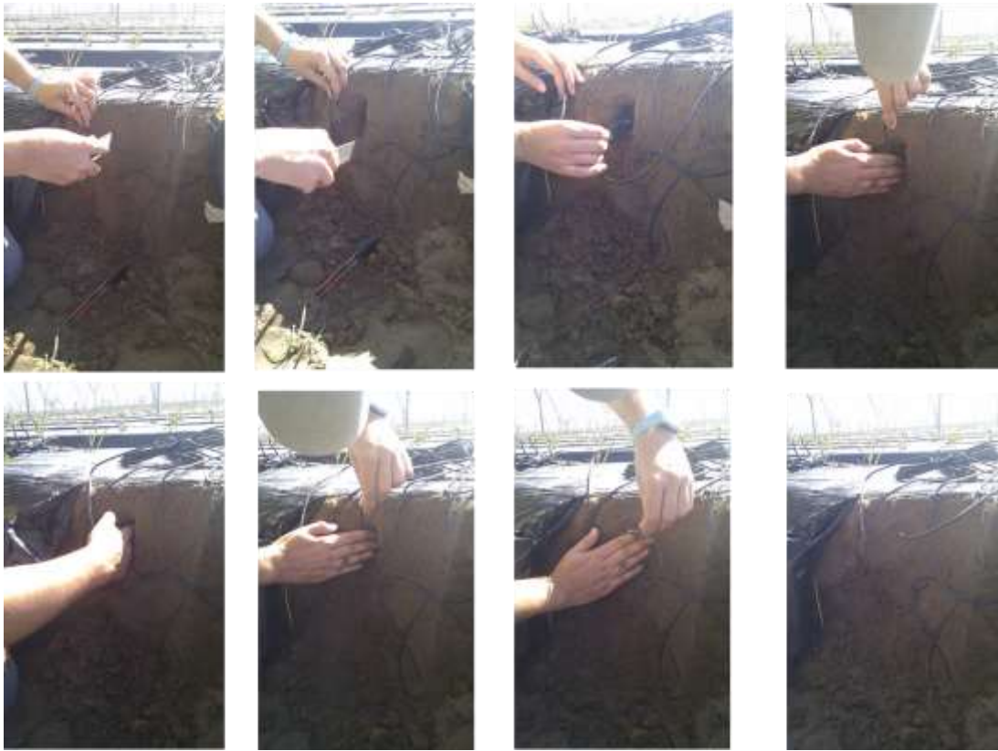
Figura 9. Instalación de sondas ECH2O
