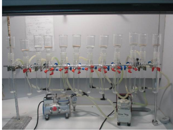
Figura 15. Detalle del sistema de extracción y separación de grasa
