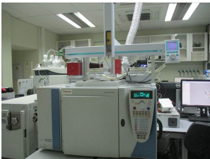
Figura 26. Detalle del cromatógrafo de gases acoplado al Combi-Pal y al espectrómetro de masas triple cuadrupolo
