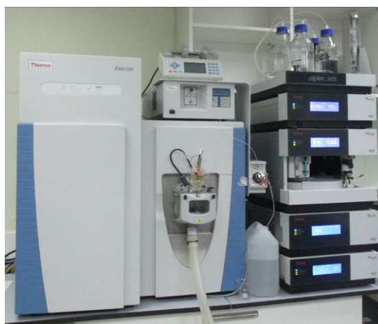
Figura 25. Detalle del cromatógrafo de líquidos acoplado al espectrómetro de masas de alta resolución
