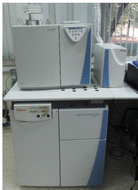
Figura 27. Detalle del analizador elemental acoplado al espectrómetro de masas de relaciones isotópicas
