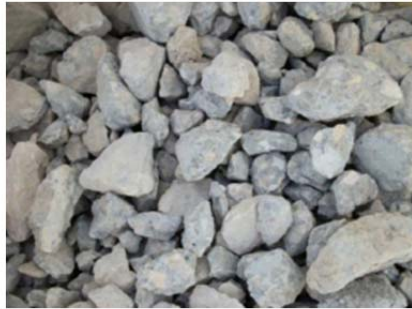
Figura 2.14: Áridos reciclados de hormigón
