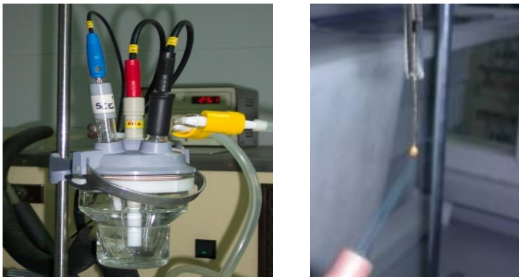
Figura 3. Celda electroquímica Metrohm y electrodo poliorientado de oro (limpieza).
