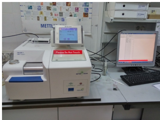
Figura 19. Equipo de TGA/DSC 1 Star System Mettler Toledo (Grupo FQM-175).
