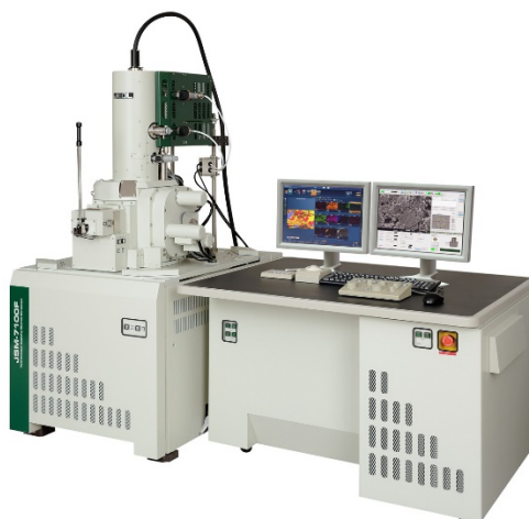
Figura 21. Equipo SEM JEOL JSM 7800 F (SCAI UCO).
