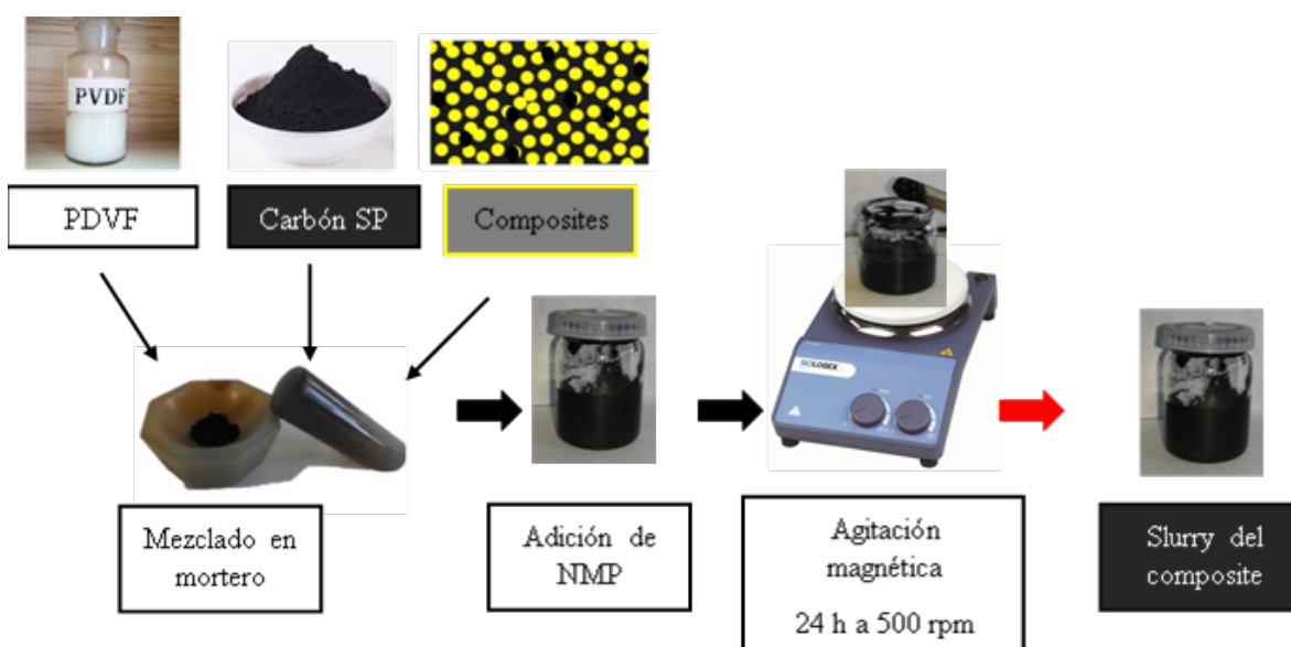
Figura 25. Esquema de preparación de la mezcla electródica (slurry).
