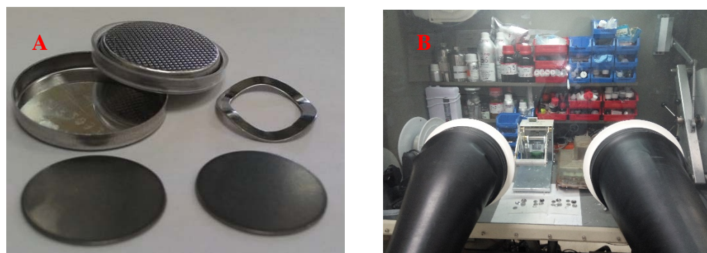
Figura 27. A) Componentes de una celda tipo botón; B) Caja de guantes.
