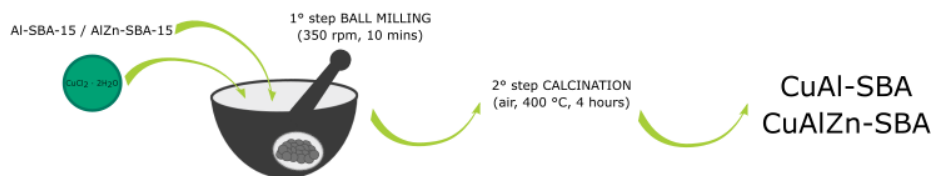
Fig. 8 Pictorial representation of the synthetic procedure of CuAl-SBA and CuAlZn-SBA.
