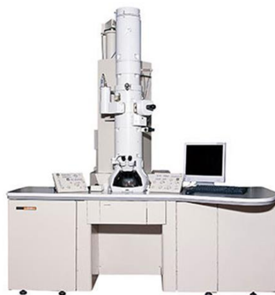
Figura 2. Equipo de microscopía electrónica de transmisión JEOL JEM 2100 del SCAI-UCO, imagen obtenida de “ https://www.jeol.co.jp/en/products/detail/JEM-2100.html ”
