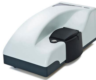
Figura 11. Equipo Zeta-sizer Nano que permite medir DLS y ZP (imagen obtenida de “ https://www.malvernpanalytical.com/es/products/product-range/zetasizer-range/zetasizer-nano-range/zetasizer-nano-zs ”)
