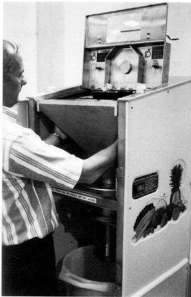
Figure 1c. Extracción de la tolva tolva
