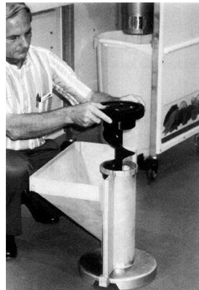
Figure 1d. Extracción del tornillo sinfín de la
