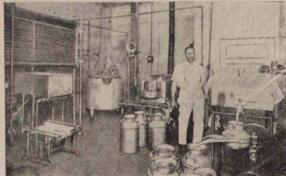
Las máquinas y aparatos Creamery Package instalados en esta pequeña lechería moderna, consisten en una pasteurizadora, enfriadora tubular, máquinas para llenar y lavar botellas, una máquina refrigeradora y una desnatadora.
