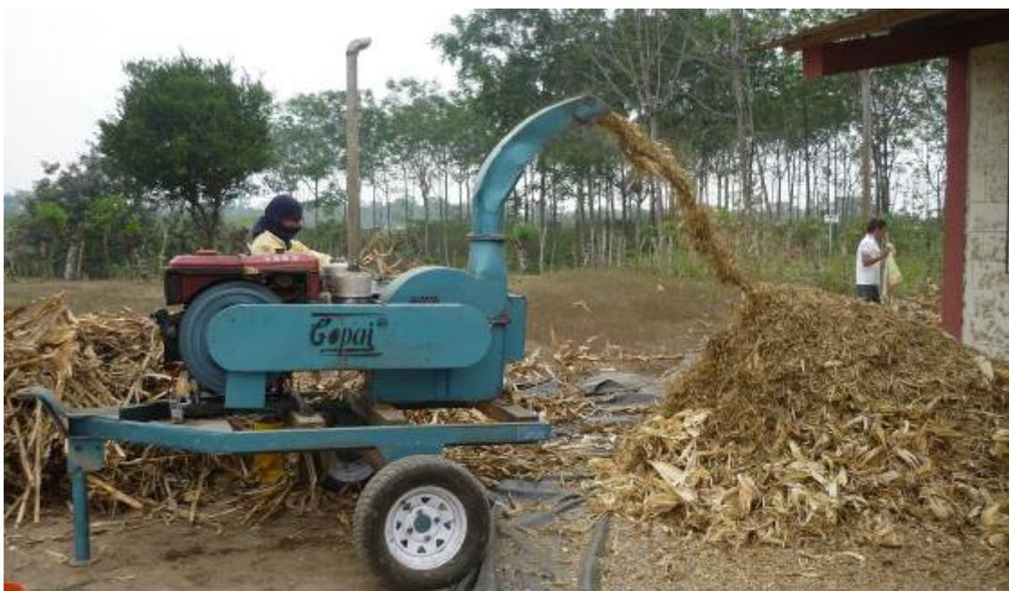
Figura 14. Detalle de la fase de preparación de la mezcla: operación de picado.
