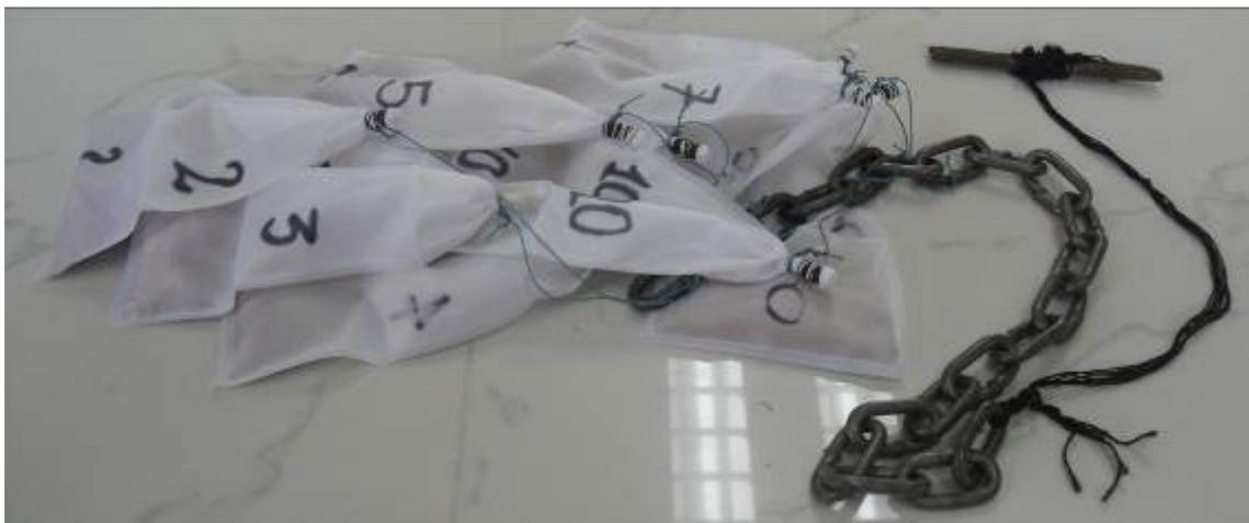
Figura 20. Detalle de las bolsas de nylon para el estudio de degradabilidad in situ.
