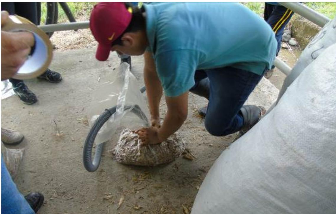
Figura 18. Detalle de la fase de preparación de la mezcla: operación de extracción del aire (condiciones anaerobias).
