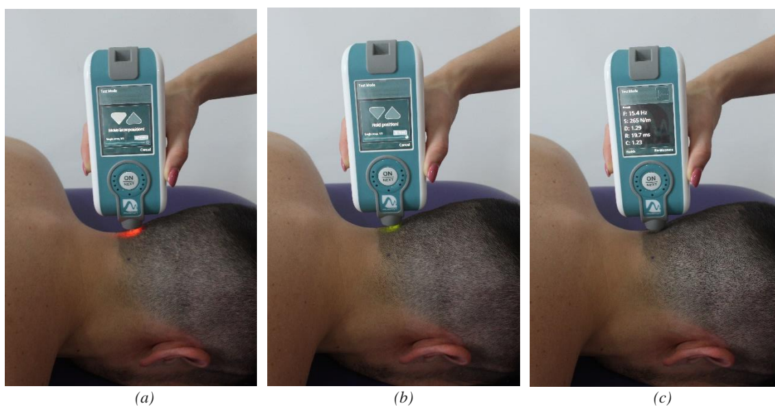
Figura 1. Señal lumínica de adecuación de presión sobre la sonda del MyotonPRO®. (a) Señal roja, indica presión insuficiente o excesiva, (b) señal verde, indica presión y orientación adecuadas de la sonda, (c) output resultado de los parámetros evaluados.
