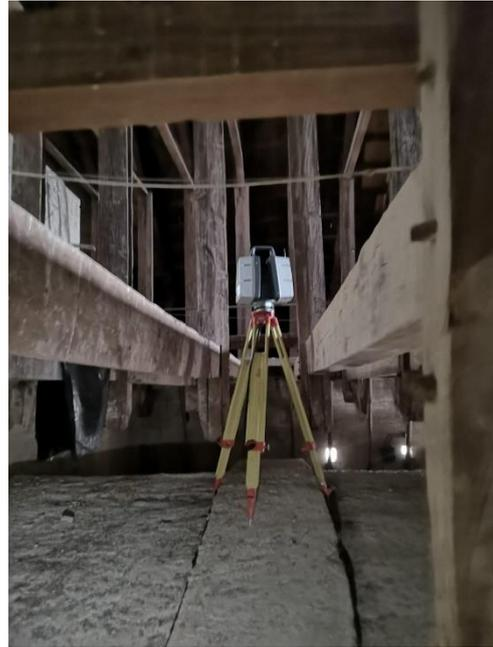
*Imagen 16. Estacionamiento del escáner láser 3D en el punto más alto de la bóveda. Fuente: propia.*
