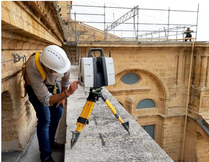
*Imagen 19. Fotografía de la realización de los estacionamientos en el exterior de la cubierta. Fuente: propia.*
