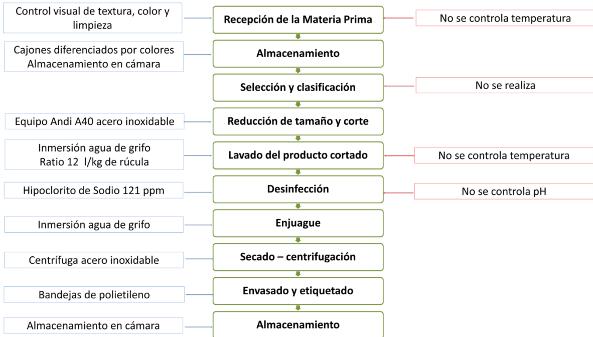
Figure 3.1. Diagrama de flujo del proceso de elaboración de rúcula lista para consumo en la Ensaladas Prácticas S.R.L. Izquierda: procedimientos aplicados. Derecha: deficiencia en el procedimiento.
