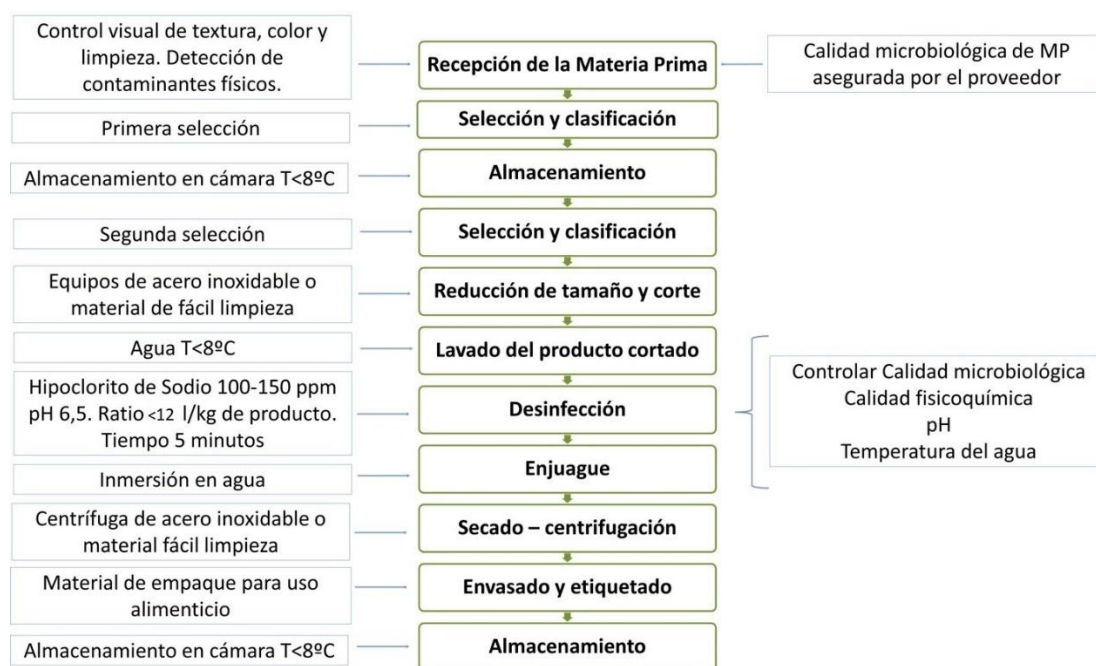
Figure 3.3. Diagrama de flujo del proceso de elaboración de rúcula lista para consumo optimizado
