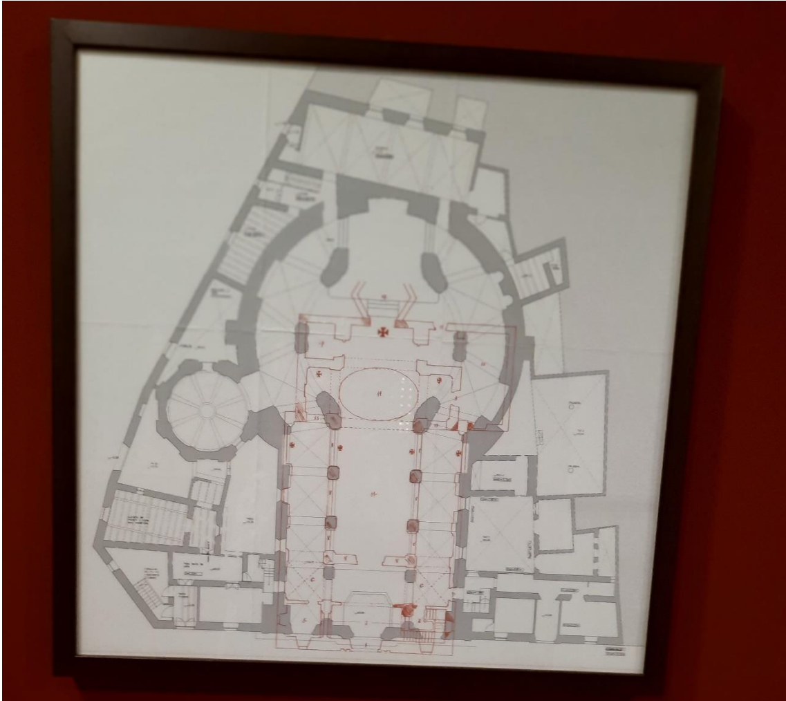
Figura nº 207. Plano actual de la Iglesia del Juramento de San Rafael en Córdoba y superposición del plano de 1795 realizado por Francisco Javier Vázquez Toja. Fuente: Centro de Interpretación de la Iglesia del Juramento de San Rafael.
