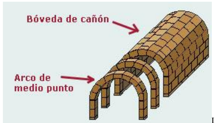
Figura nº 232. Bóveda de cañón. Fuente: DICCION ARTE.
