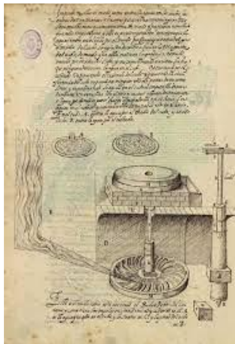
Figura nº 119. Molino de regolfo. Fuente: https://www.juntadeandalucia.es 89
