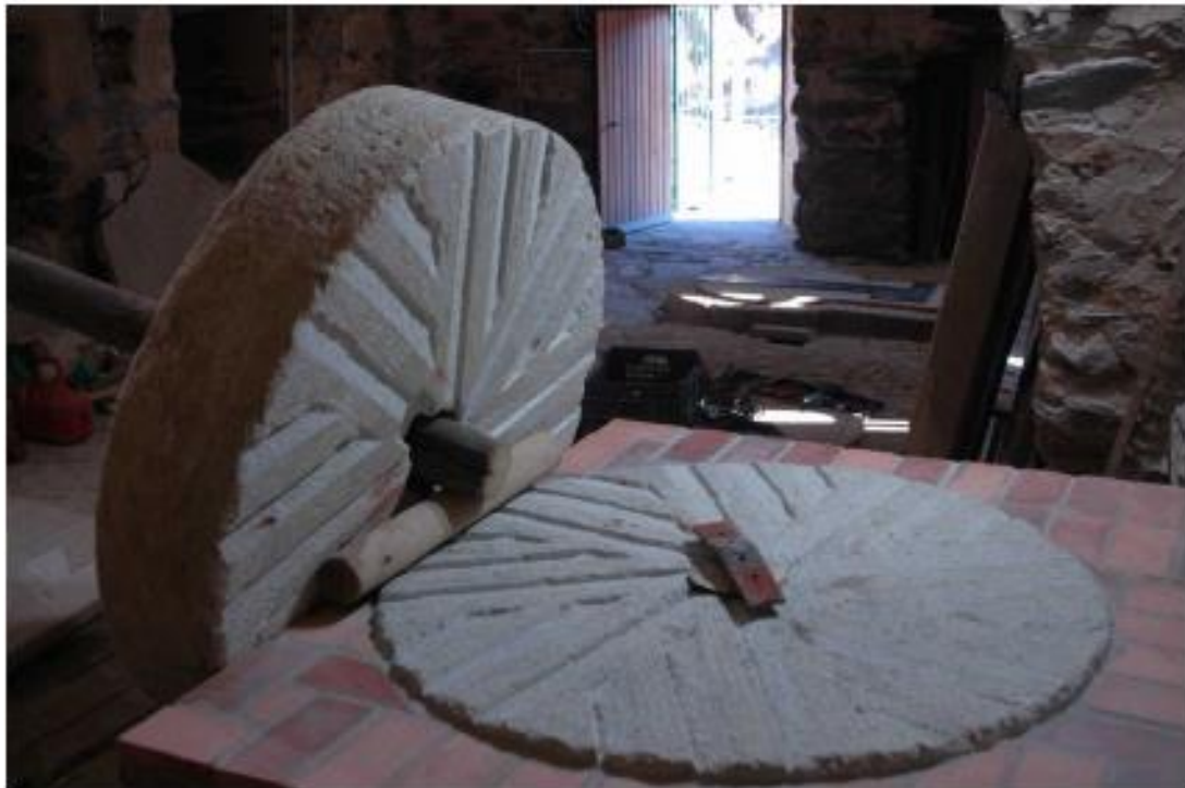
Figura nº 121. Piedra solera y volandera dotada de picadura. Fuente: http://www.molinosdeextremadura.com/
