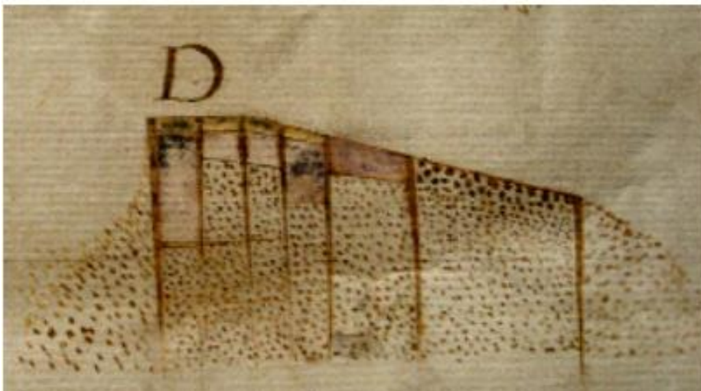
Figura nº 124. Corte transversal de una azuda, detalle del plano de Mariano Luque 1788 93 Fuente: Archivo de la Catedral de Córdoba.
