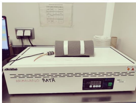
Figura 22. A) medidor de presión LE 5001. B) Representación de la medición arterial. La rata se encuentra dentro del cepo cubriendo su vista, con el transductor y el manguito en la cola y sobre una placa calefactora
