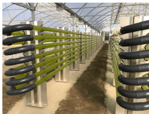
Figura 3. Fotobiorreactores tubulares de la Planta ÁGORA-SABANA
