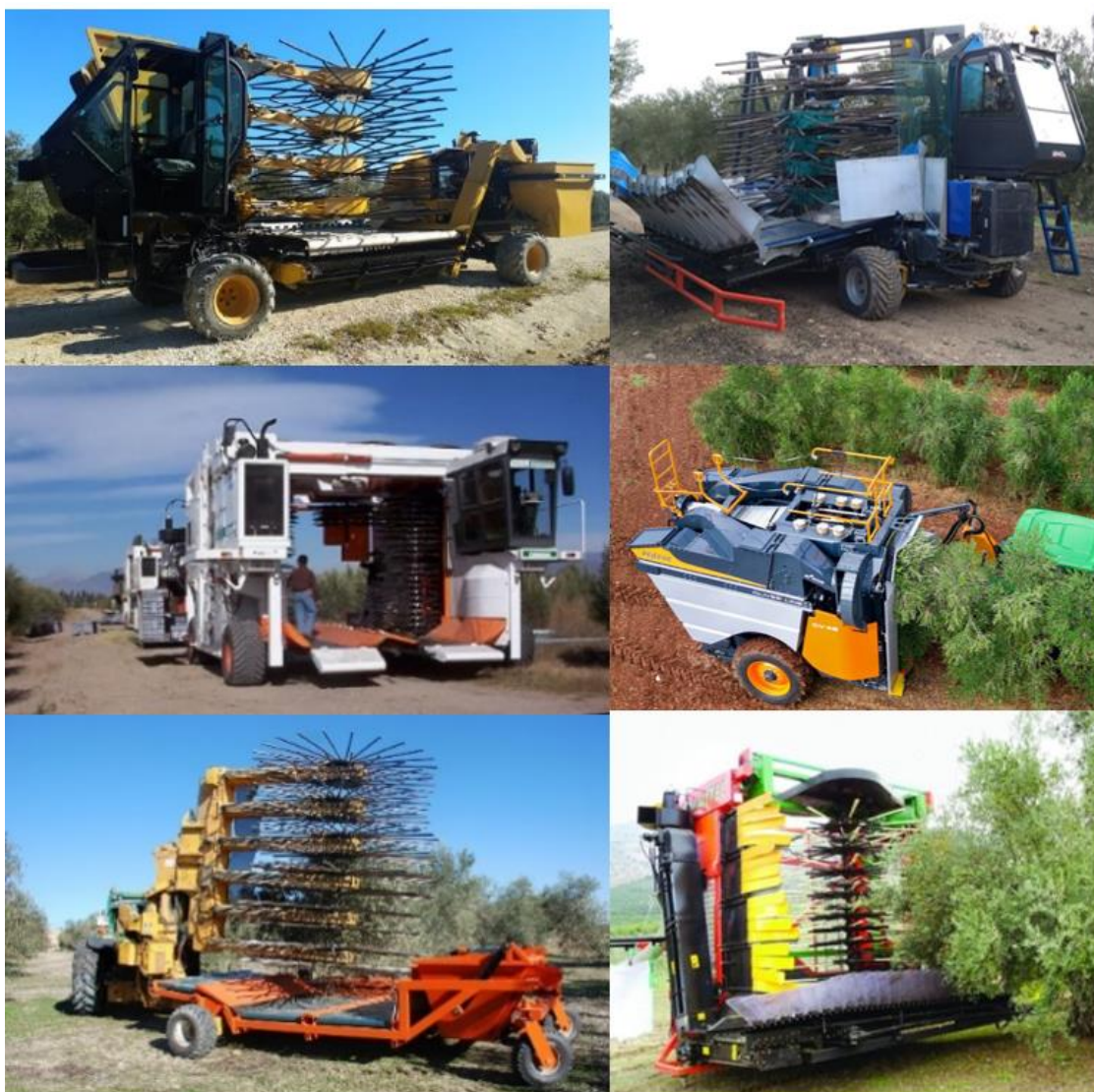
Figura 5. Cosechadora de sistema lateral de copa para la recolección integral de olivar de intensivo. (1) y (2) prototipos de línea 11 dentro del proyecto Innolivar empresas de Moresil y Talleres Mata Campos, respectivamente, (3) MAQTEC Colossus XL, (4) Pellenc CV5045, (5) Oxbo 3210 y (6) Prototipo CPP Mecaolivar MAQTEC.
