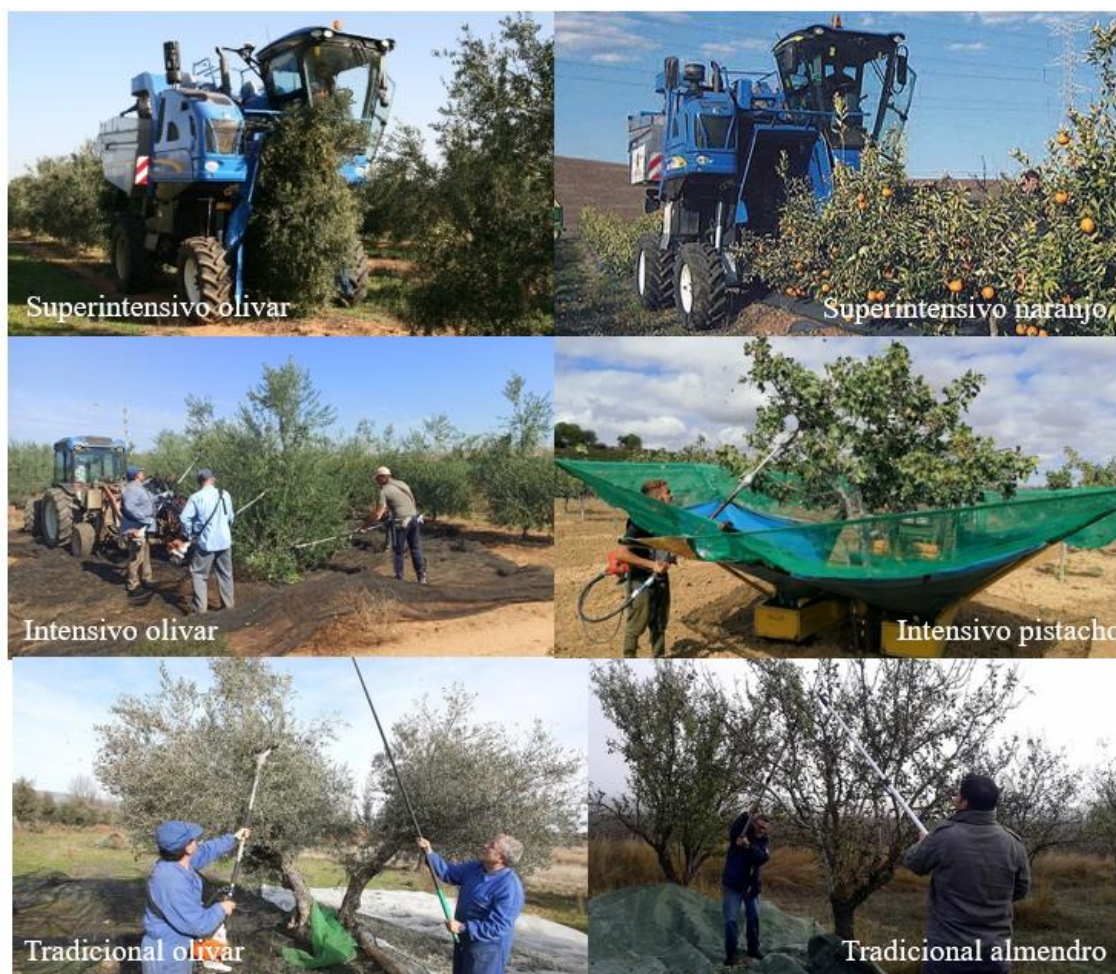
Figura 3. Configuraciones de árboles en superintensivo (arriba), intensivo (medio) y tradicional (abajo)
