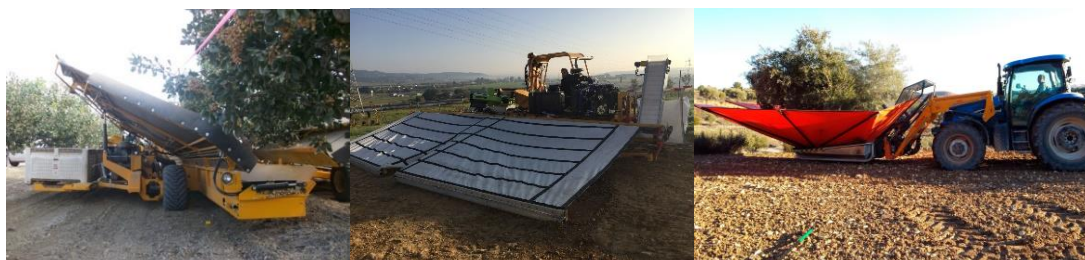
Figura 4. Sistema side-by-side (izq.), sistema roll-out (centro) y sistema de paraguas invertido (dcha.).
