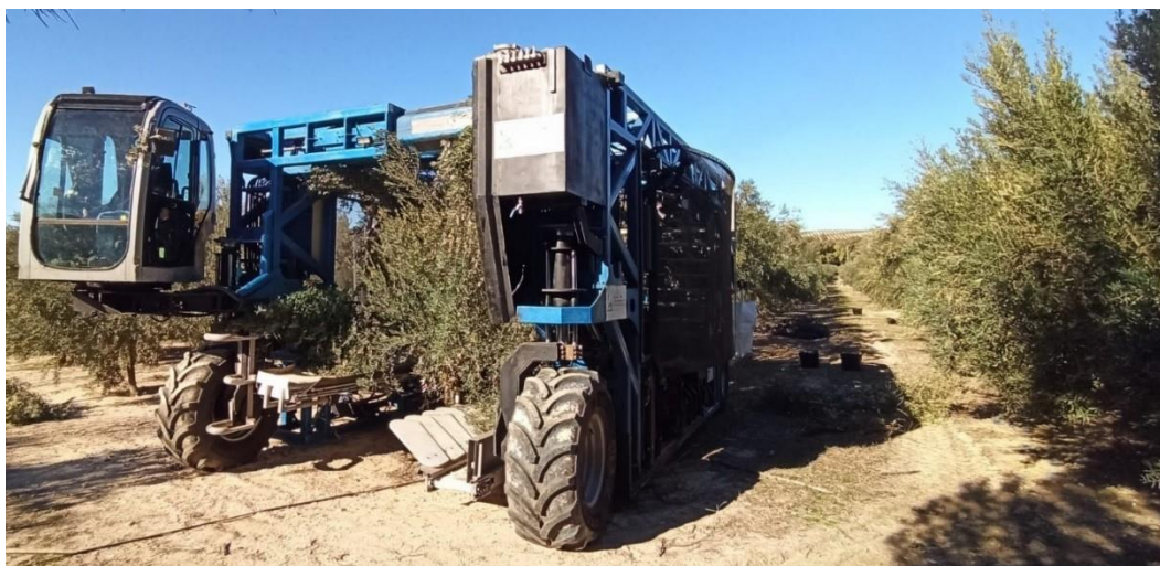
Figura 30. Prototipo trabajando en olivar de intensivo.
