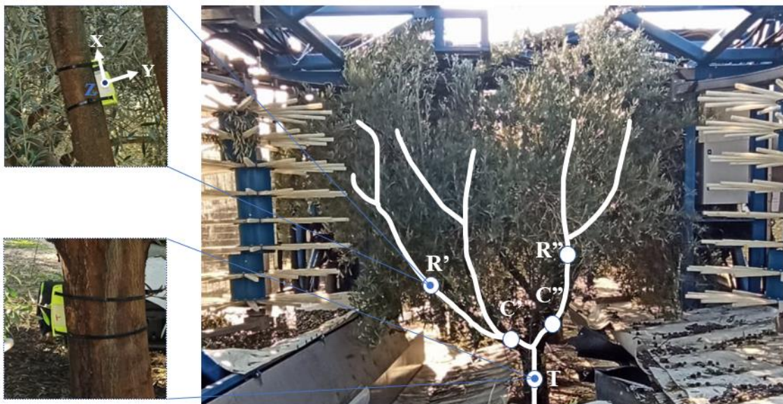
Figura 31. Acelerómetros colocados en el tronco (T), en la cruz (C, C'') y en las ramas (R', R'').
