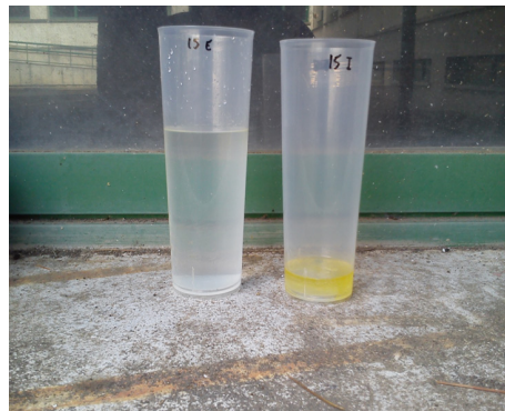
Figura 5 | Muestras de ejemplo, tomadas del separador con R=13.15 mm, con un rendimiento cercano al 100%. La de la parte izquierda fue recogida de la sección exterior del separador y la de la derecha fue tomada del lado interior de dicho dispositivo.
