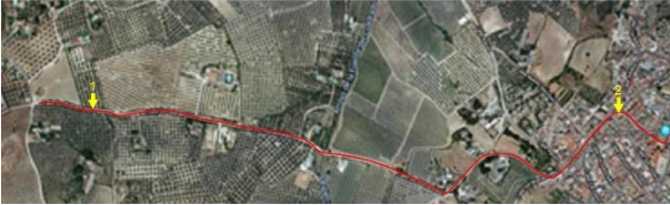
Figura 35: Calle de los Manantiales en Google Maps, con el recorrido de la tubería (rojo) y situación de tramos de la conducción encontrada (1 y 2).
