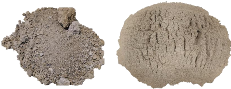
Fig. 1. 10. Ceniza de fondo de biomasa (CFB) (Izquierda) y Ceniza volante de biomasa (CVB) (Derecha)
