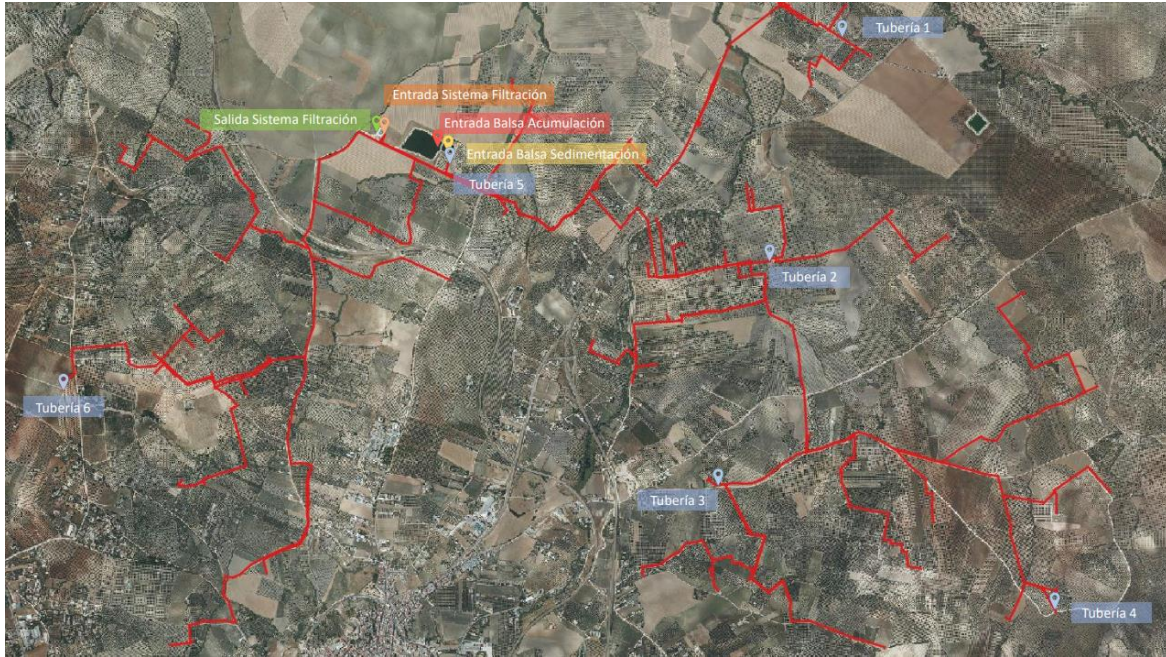
Figura 9. Puntos de muestreo de la calidad del agua en la CR Tintín
