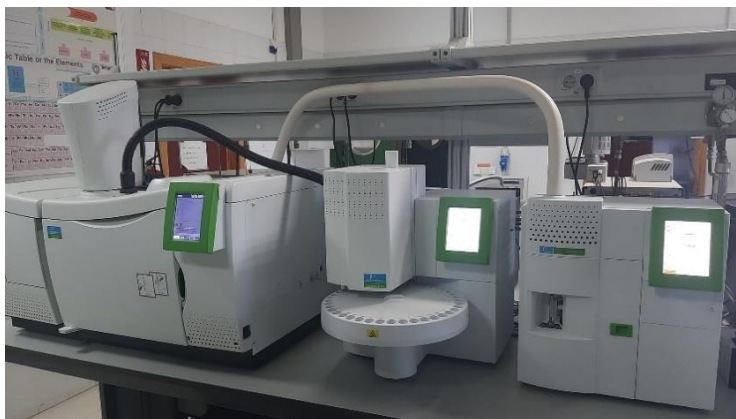
Figura 23. Cromatógrafo de gases acoplado a espectrometría de masas, con módulos complementarios de desorción térmica y espacio de cabeza (PerkinElmer®).
