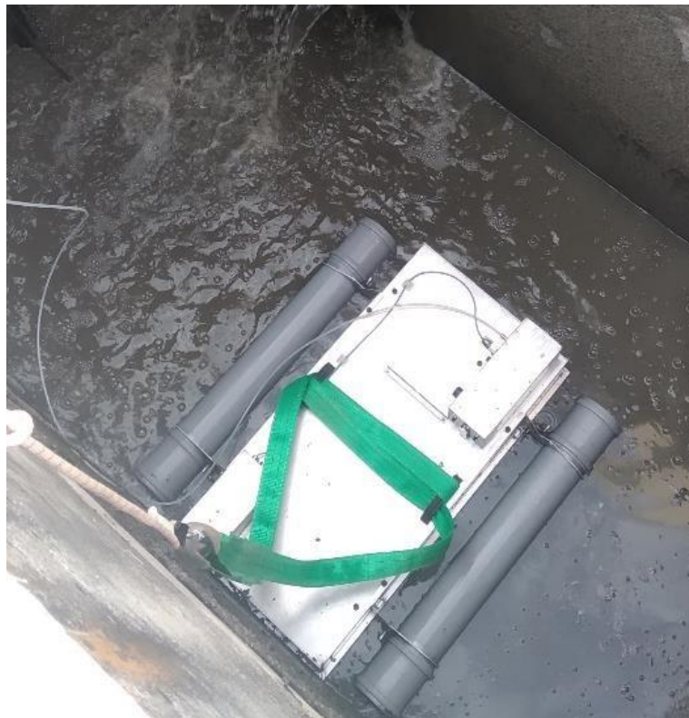
Figura 59. Campana Lindvall operando en la toma de muestras gaseosas de una EDAR.
