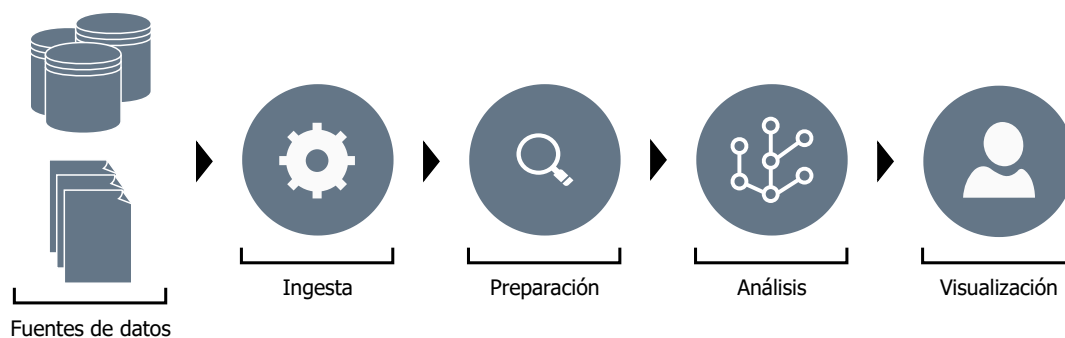
Figura 2.1: Ejemplo de las fases de un data pipeline .
